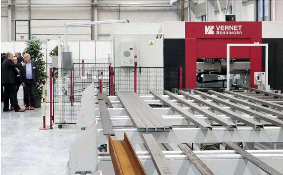
Innovative Sägebohranlage, von Behringer in die neue Produktionshalle integriert (Bilder: Dag Heidecker)
