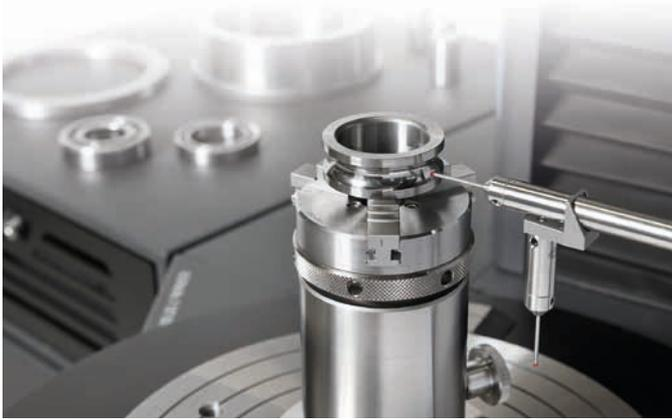
Die Spezialisten für Präzisionsmessung und Werkzeugmaschinen stellen Lösungen für Komplettmessungen beispielsweise an Wälzlagern zur Verfügung (Bilder: Klingelberg)
