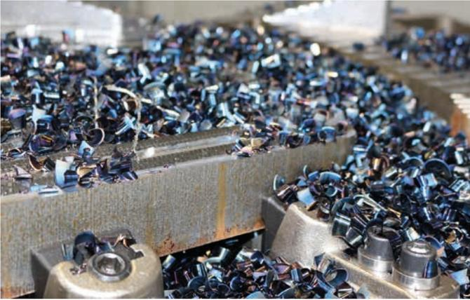
Bei der Bearbeitung wird relativ viel Material abgetragen: Die fertige Grundplatte wiegt nur noch 84 kg
