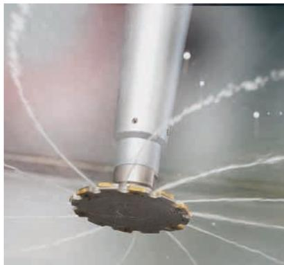
335.19 (Nutbreite 4 mm bis 8 mm) und 335.18 (Nutbreite 4 mm bis 12 mm) lässt sich das Potenzial in puncto Produktivität beim Nut- und Trennfräsen deutlich steigern. Die Produkte von Seco Tools, Düsseldorf, überzeugen in den herausforderndsten Werkstoffen – auch bei hohen Geschwindigkeiten.
