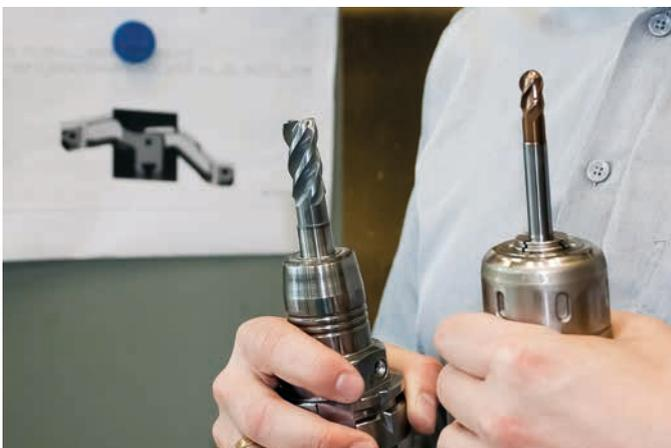
Auf einer 3-achsigen DMC 75 V linear wurde der Schieber erstmals trochoidal mit einem Vollhartmetall-Fräser EPSM (l.) geschruppt und mit dem EHHB-Kugelfräser (r.) vorgeschliffen (Bilder: MMC Hitachi Tool)
