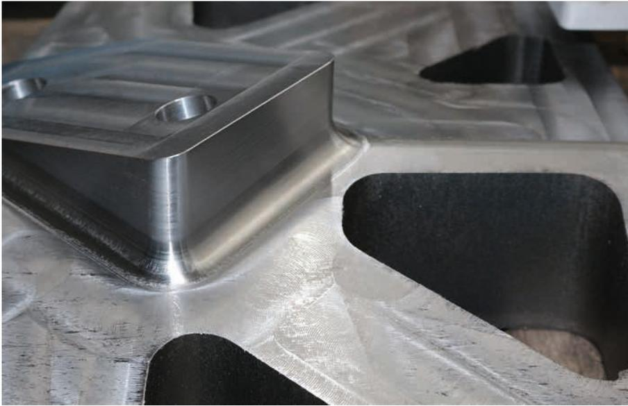
Der Baustahl S355JR der 600 x 300 x 150 mm großen und etwa 160 kg schweren Teile lässt sich gut zerspanen – herausfordernd bei der Aufgabe sind eher die harte Brennruste sowie die vier Taschen. Mit dem Dropmill-Kugelkopffräser konnte Thomé am Zapfen die Kontur mit dem Radius von 15 mm sauber einbringen.
