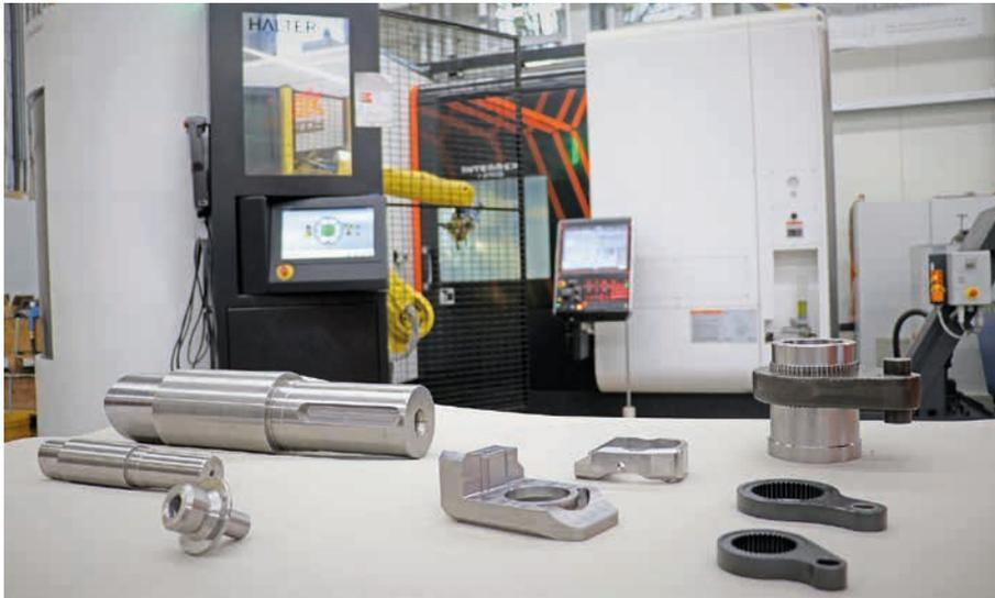
Die Heinz Knöpfle GmbH verfügt über 18 teils roboterautomatisierte 3-, 4- und 5-Achs-Bearbeitungszentren (BAZ) sowie zwei Drehfräszentren, auf denen der Zerspanungsdienstleister ein breites Bauteilspektrum fertigt (Bilder: Ceratizit)
