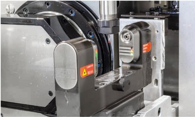
Selbst winzige Werkzeuge mit einem Durchmesser von 15 hundertstel Millimeter vermisst das Lasermesssystem LC50-Digilog zuverlässig (Bilder: Blum-Novotest)
