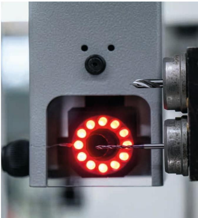
Die horizontale Einspannsituation auf dem Einstell- und Messgerät „hyperion“ ist exakt der Einspannsituation auf der Maschine nachempfunden (Bilder: Zoller)
