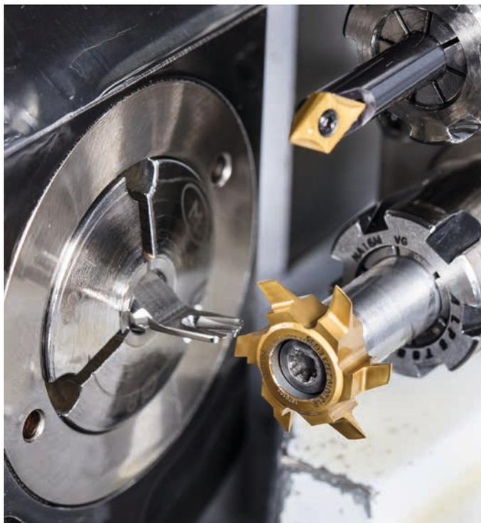
Schlitzfräsen der dünnwandigen Klinge mit dem Zirkularfräser 613 (Bilder: Horn – Sauermann)
