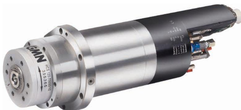
Beispielsweise ist die Hochgeschwindigkeitsspindel HCS 120-75000/10 mit Sensoren ausgerüstet, welche die zur Spindel- und Prozessüberwachung relevanten Messsignale erfassen (wie Informationen über Lager-, Motor- und Kühlmitteltemperaturen, Drehzahl, Schwingungen, Wellenverlagerungen, Spannzustand des Werkzeugs). Alle Daten werden in der Spindel zentral auf einer Platine gespeichert sowie verarbeitet und sind für Diagnose-
