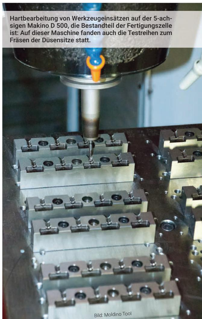
Hartbearbeitung von Werkzeugeinsätzen auf der 5-achsigen Makino D 500, die Bestandteil der Fertigungszelle ist: Auf dieser Maschine fanden auch die Testreihen zum Fräsen der Düsensitze statt.
