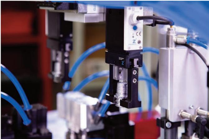
Ein GEP2000-Greifer des süddeutschen Automationspezialisten greift einen Batteriepol.
