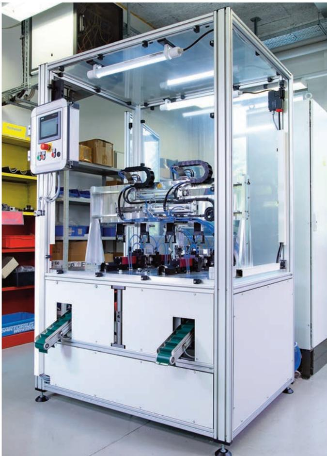
Der Batteriepol-Glättautomat besteht unter anderem aus einem Gestell mit Antriebseinheit und Unterbau mit verschiedenen Walzeinheiten, Greifereinheit, Schaltschrank, Zuführ- und Sortiereinheit sowie Bedienpanel.
