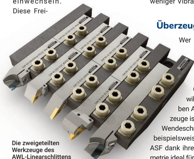
Die zweigeteilten Werkzeuge des AWL-Linearschlittens von Arno Werkzeuge mit Träger und Anschlagsteil lassen sich mit wenigen Handgriffen lösen und befestigen.
