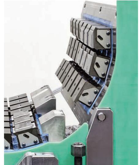
Bewegliche Polverlängerungen gewährleisten auf Antrieb eine deformationsfreie Spannung und gleichen im gespannten Zustand Werkstücktoleranzen in zwei Richtungen aus.
