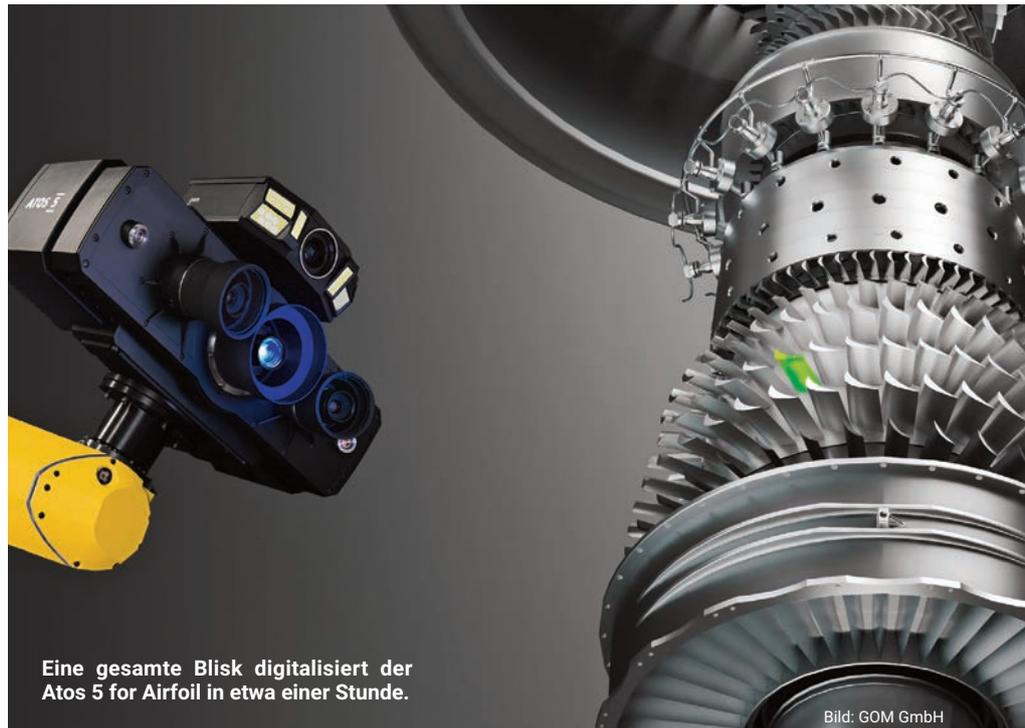
eine neue Schaufel, die aufgrund von Defekten ersetzt werden muss, liegen bei über 10.000€. Können die Fehler am Bauteil durch digitale Flächenrückführung und Reverse Engineering beispielsweise im Metall-3D-Druck ausgebaut werden, sind beträchtliche Einsparungen möglich.
