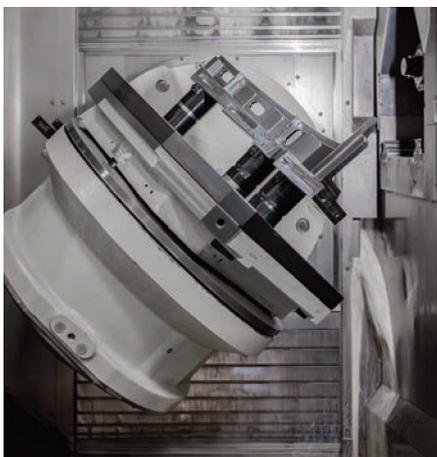
Auf fast allen der 22 Maschinen bei Koller in Dietfurt sind AMF Nullpunktspannsysteme im Einsatz.
