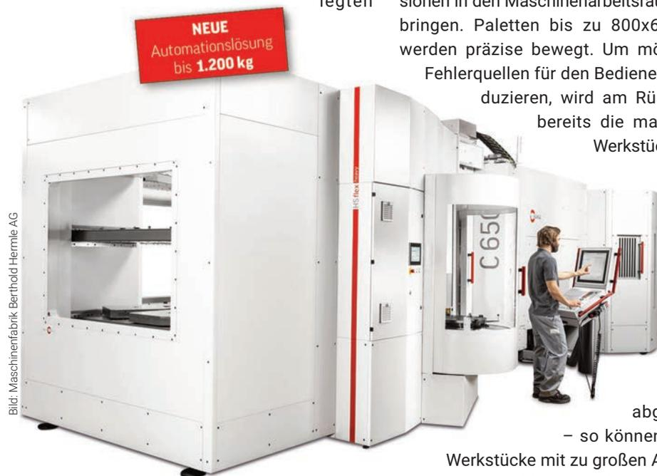
Handlingsystem HS Flex Heavy mit zwei Speichermodulen, adaptiert an ein 5-Achsen-Bearbeitungszentrum C 650
