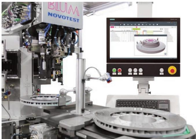
Die neue Mess- und Auswerte-Software M4P wurde speziell für die Post-Prozess-Messanlagen von Blum-Novotest konzipiert.
