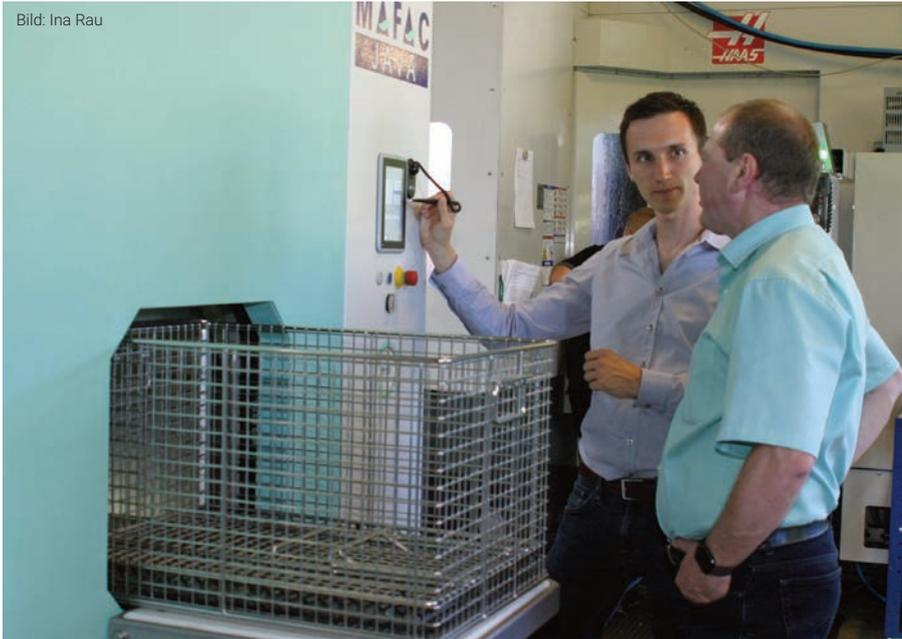
Insgesamt zwölf Programme sind in der bei Reiser installierten Java eingespeichert: Sie werden entsprechend den zu reinigenden Bauteilen über das Touch Pad aktiviert.
