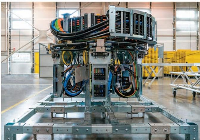
Für die Montage der vorkonfektionierten Leitungen an die Energieführungsketten und die Metallführungen benötigen die Techniker in Köln etwa 2,5 Tage.
