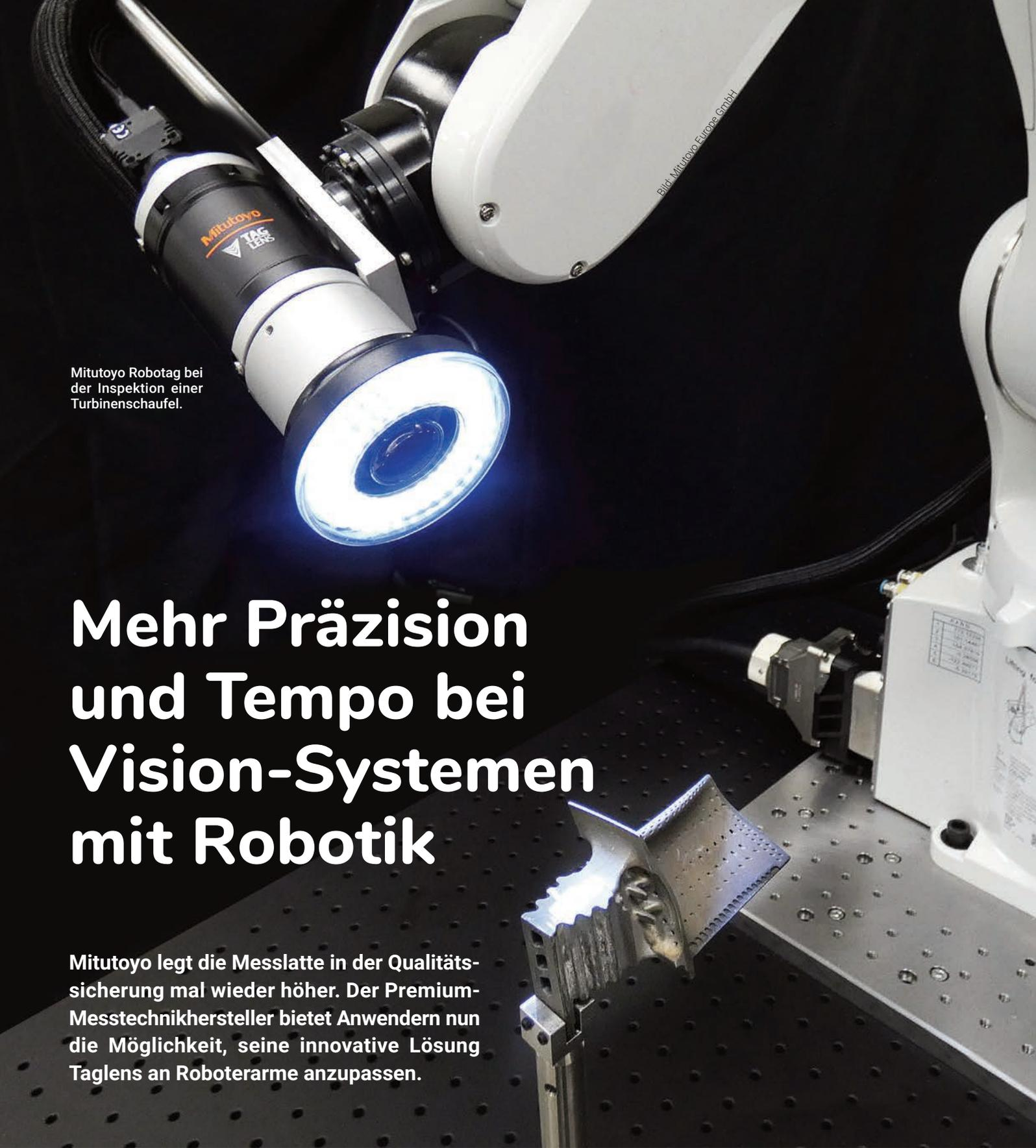
Mitutoyo Robotag bei der Inspektion einer Turbinenschaufel.
