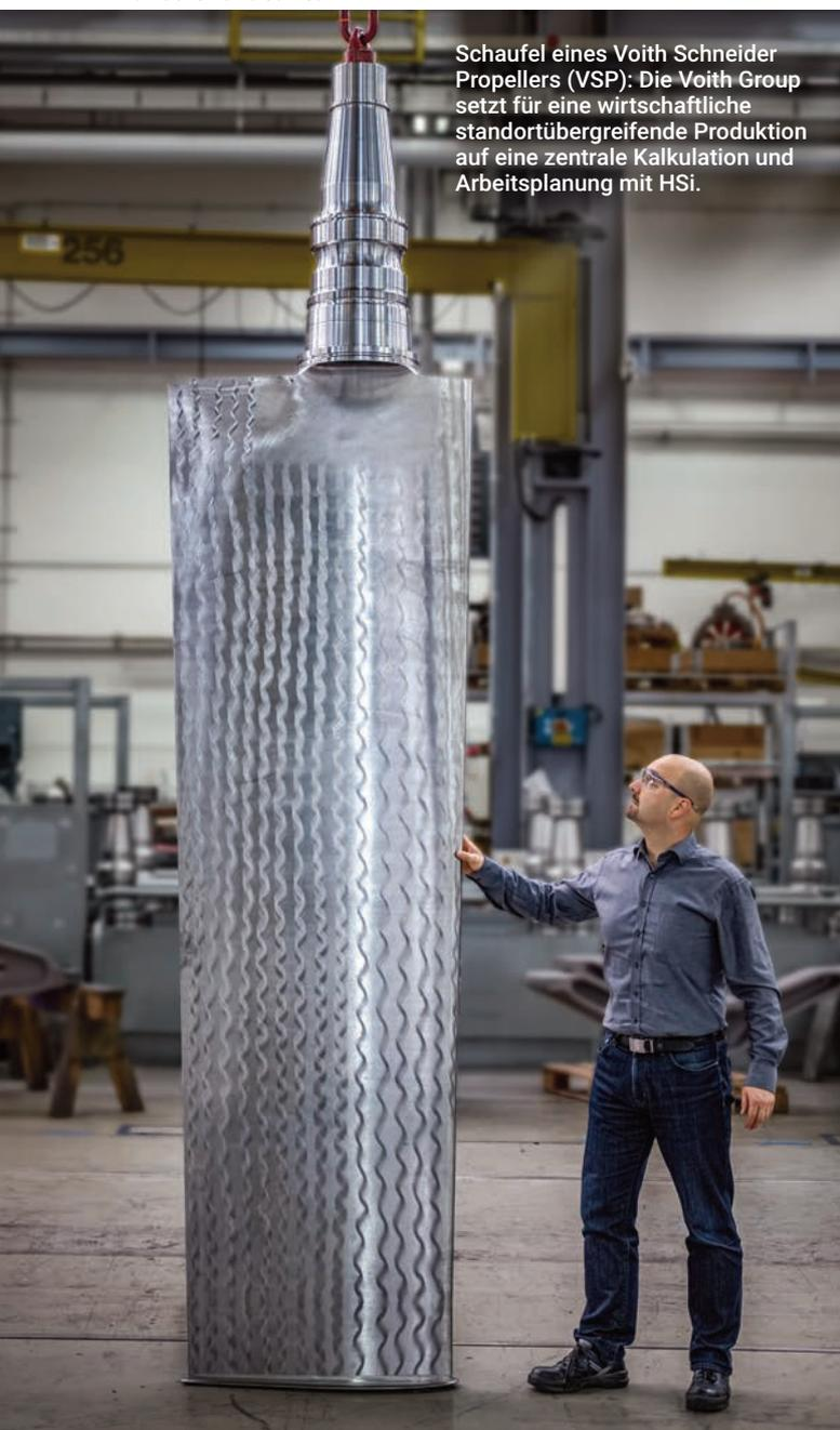
Schaufel eines Voith Schneider Propellers (VSP): Die Voith Group setzt für eine wirtschaftliche standortübergreifende Produktion auf eine zentrale Kalkulation und Arbeitsplanung mit HSi.
