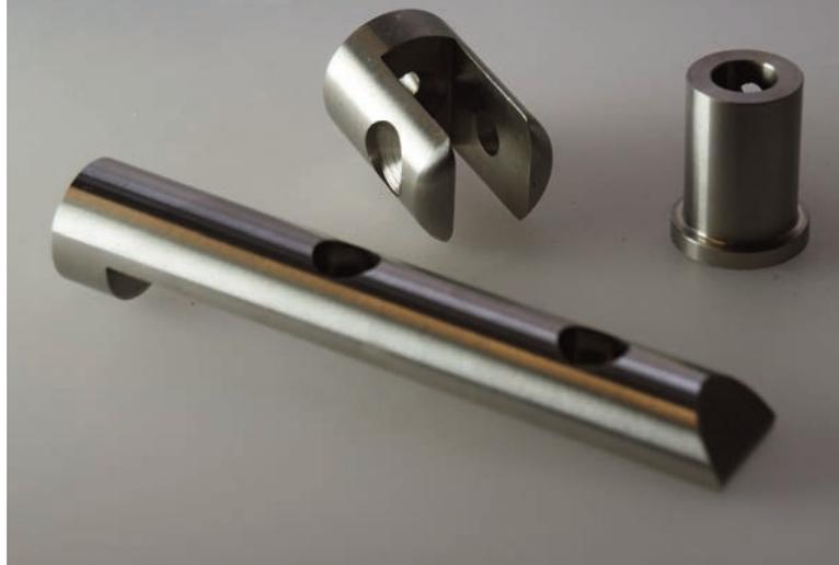
Die Beschlagkomponenten von Sysko müssen als Sichtteile frei von Kratzern und Beschädigungen sein.
