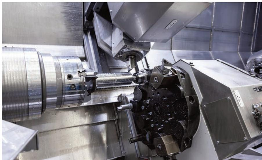
Herzstück der Maschine – die Dreh-Bohr-Fräseinheit mit X-, Y- und B-Achse.
