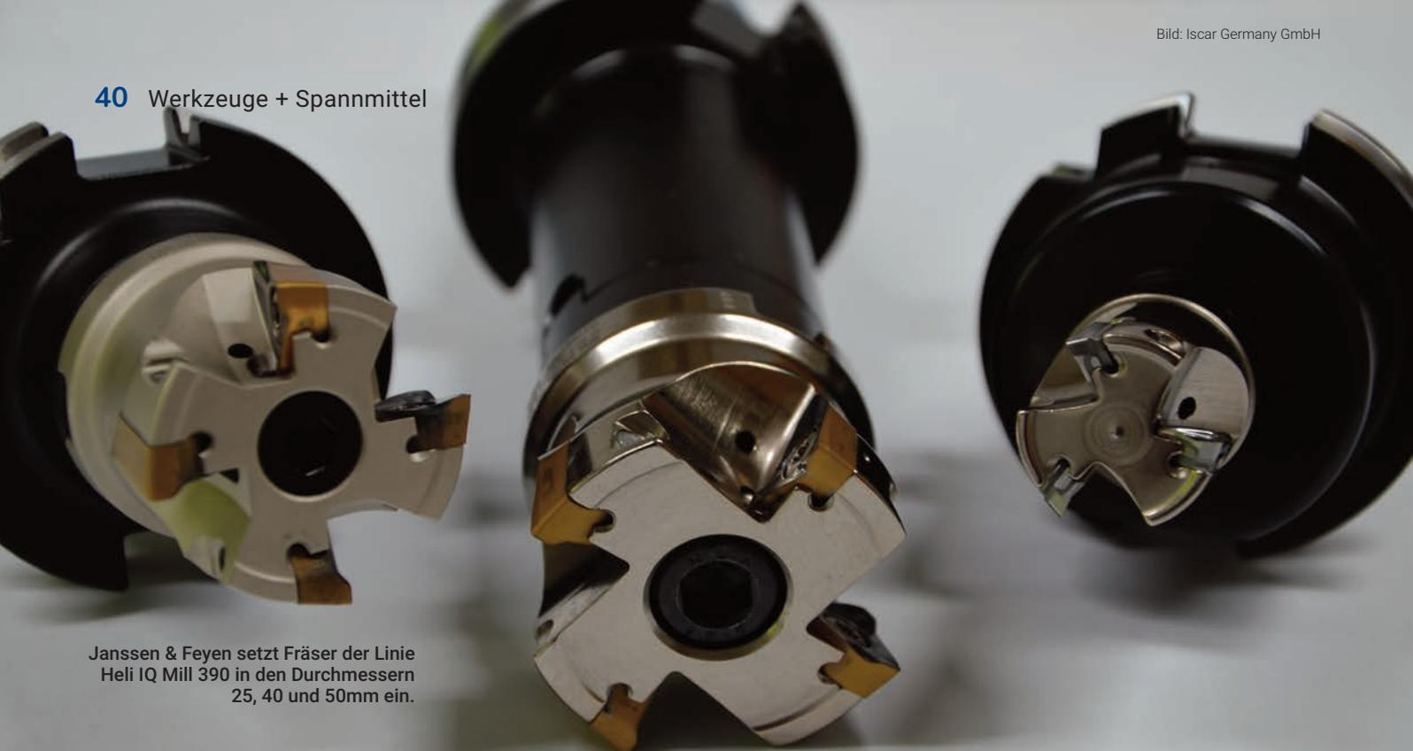
Janssen & Feyen setzt Fräser der Linie Heli IQ Mill 390 in den Durchmessern 25, 40 und 50mm ein.
