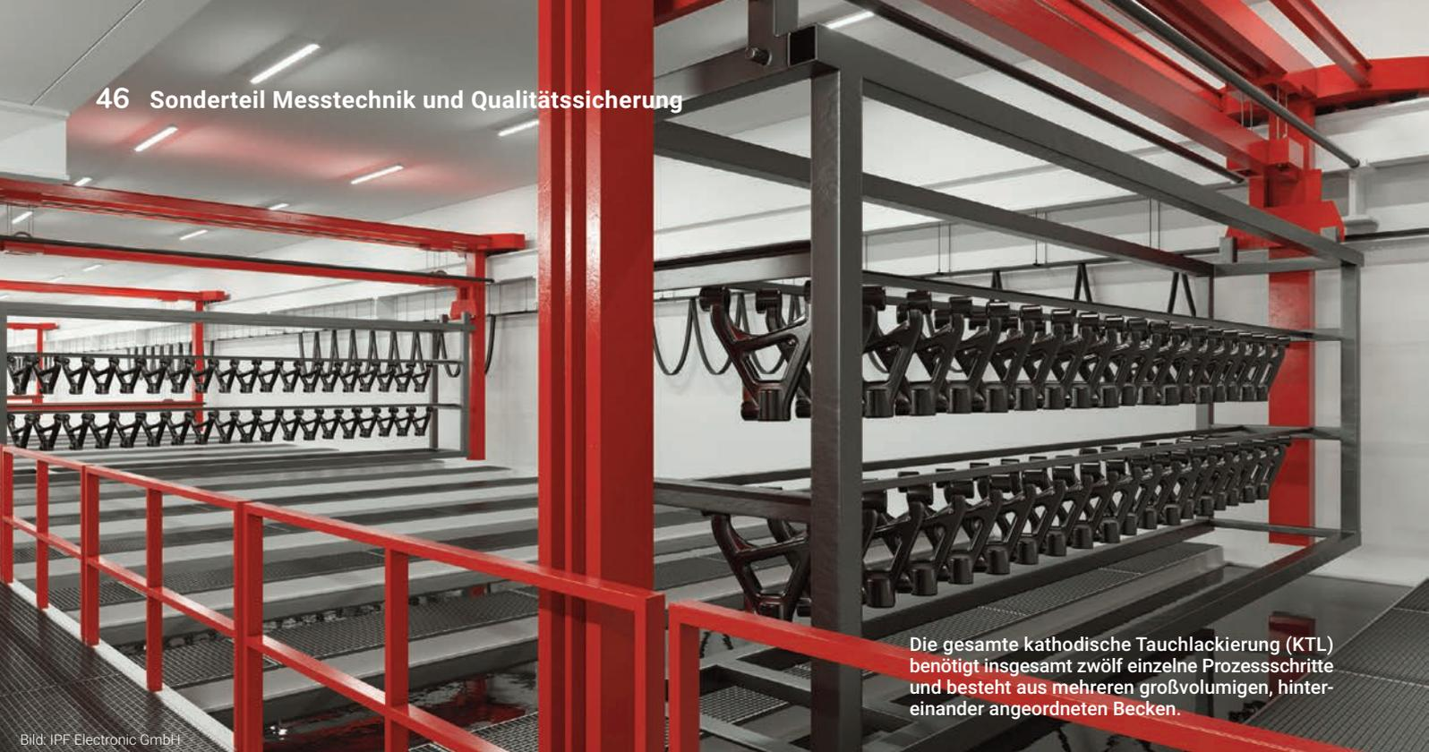
Die gesamte kathodische Tauchlackierung (KTL) benötigt insgesamt zwölf einzelne Prozessschritte und besteht aus mehreren großvolumigen, hintereinander angeordneten Becken.
