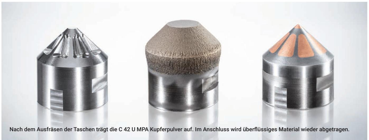
Nach dem Ausfräsen der Taschen trägt die C 42 U MPA Kupferpulver auf. Im Anschluss wird überflüssiges Material wieder abgetragen.
