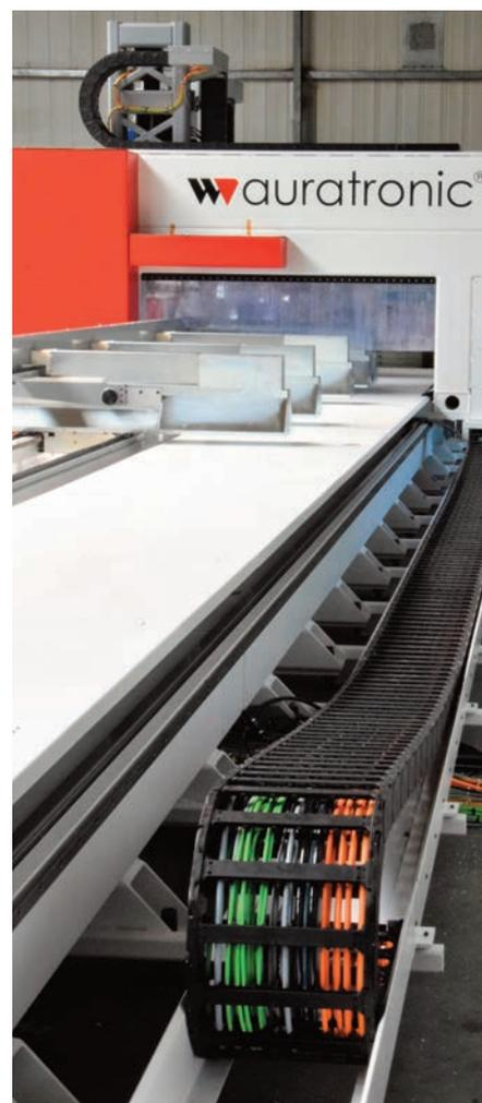
Die Energie- und Medienversorgung des Bearbeitungsportals (mit Fräsen, Bohren, Säge und Werkzeugmagazin) erfolgt über eine Energiekette aus dem E4-Programm.
