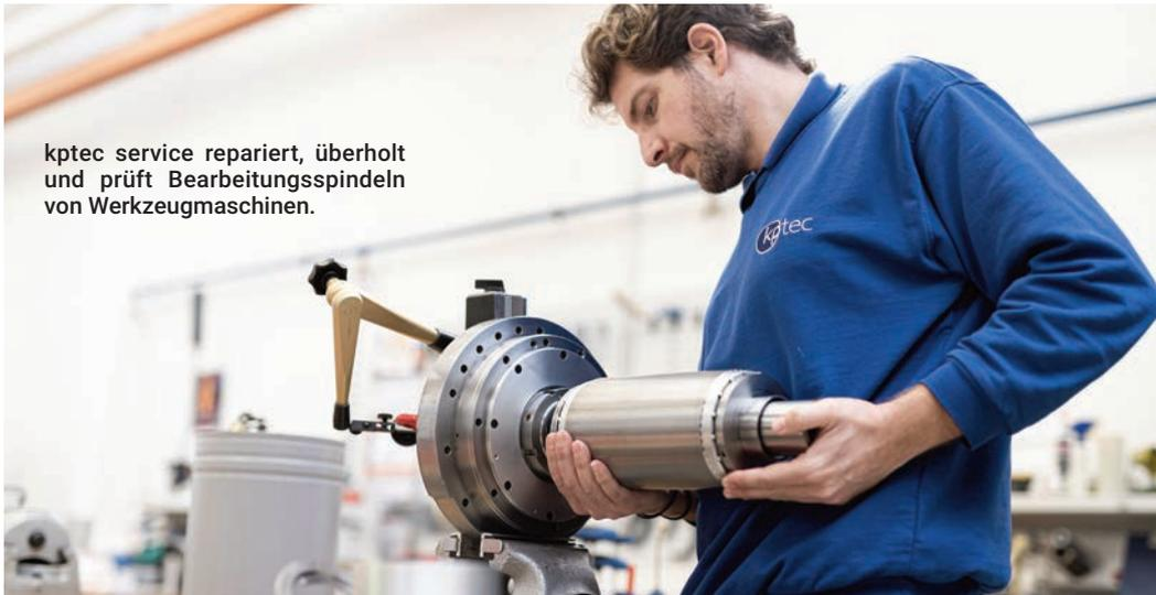
kptec service repariert, überholt und prüft Bearbeitungsspindeln von Werkzeugmaschinen.
