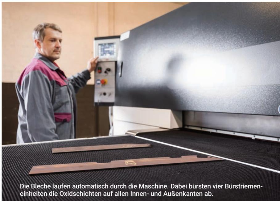
Die Bleche laufen automatisch durch die Maschine. Dabei bürsten vier Bürstriemen-einheiten die Oxidschichten auf allen Innen- und Außenkanten ab.
