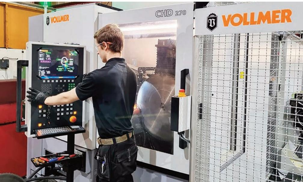
„The Saw Centre‘ in Glasgow setzt seit zwanzig Jahren auf schwäbische Schärfttechnologie aus dem Hause Vollmer. 2021 nahmen die Schotten ihre neue Schärfmaschine CHD 270 inklusive Beladesystem ND 250 in Betrieb, um hartmetallbestückte Kreissägeblätter mit komplexen Zahngeometrien in einer Aufspannung und mannlos rund um die Uhr zu bearbeiten.
