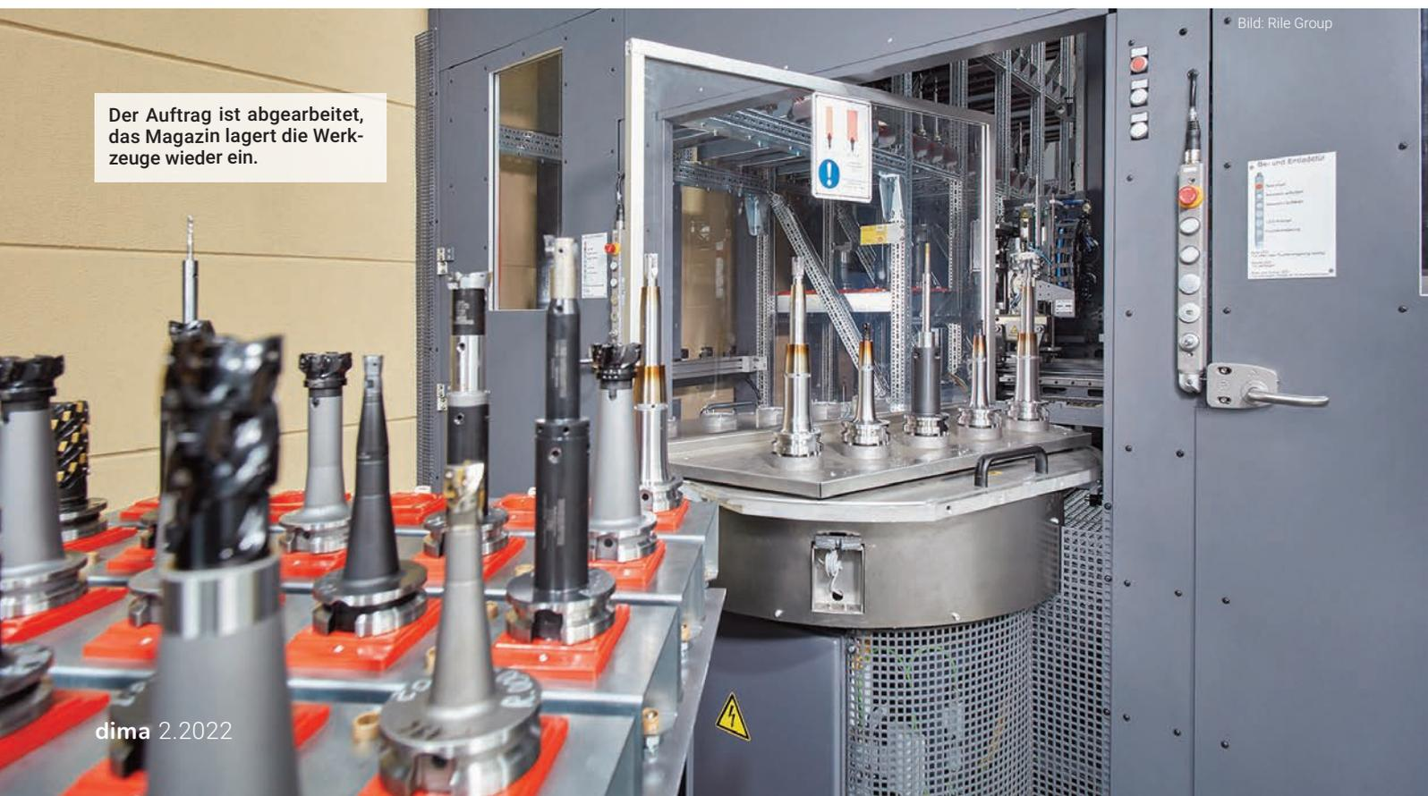
Der Auftrag ist abgearbeitet, das Magazin lagert die Werkzeuge wieder ein.
