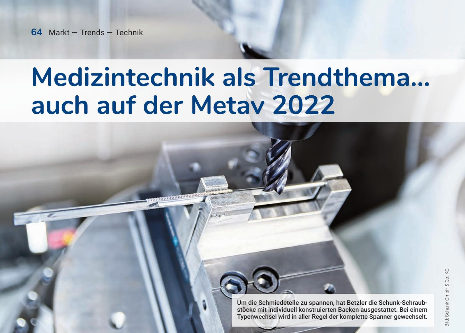
Um die Schmiedeteile zu spannen, hat Betzler die Schunk-Schraubstöcke mit individuell konstruierten Backen ausgestattet. Bei einem Typenwechsel wird in aller Regel der komplette Spanner gewechselt.
