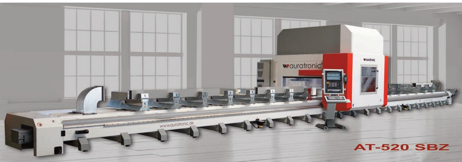
Die neue CNC-Bearbeitungsanlage für bis zu 18m lange Aluminiumprofile ist hoch automatisiert und zugleich extrem flexibel.
