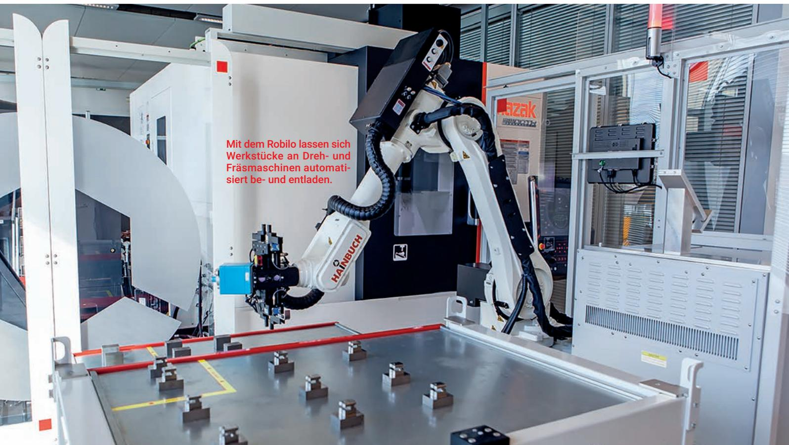
Mit dem Robilo lassen sich Werkstücke an Dreh- und Fräsmaschinen automatisiert be- und entladen.
