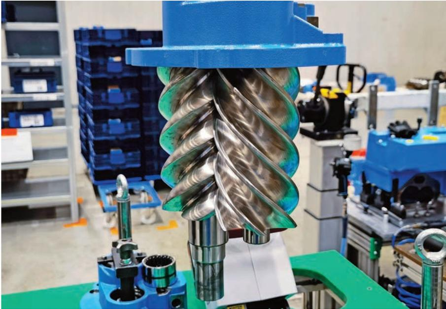
Teilmontierte Schraubenverdichter-Baugruppe, bestehend aus zwei Rotoren und dem blau lackierten Lagerdeckel
