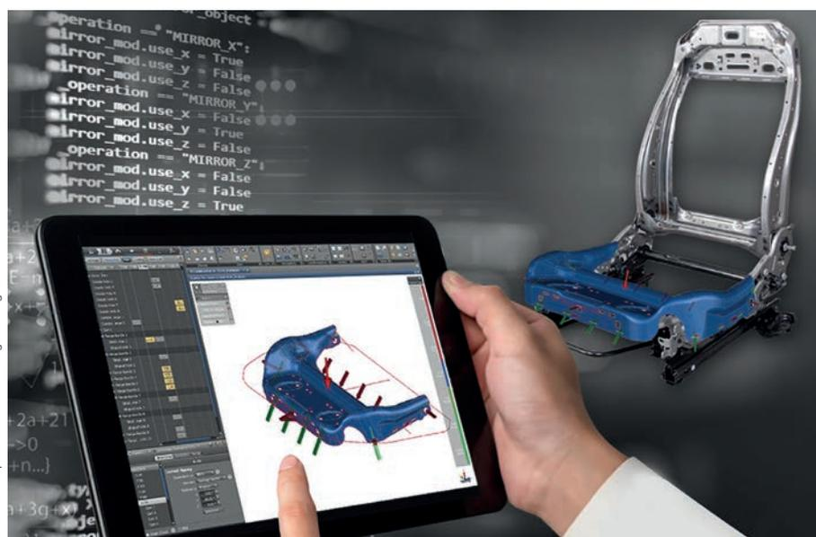
Moderne Fahrzeugsitze sind heute vor allem auch sicherheitsrelevant: Die Berechnung der Werkzeugkosten nimmt der CostEstimator auf Basis von CAD-Bauteilgeometrie und definierter Fertigungsroute vor.
