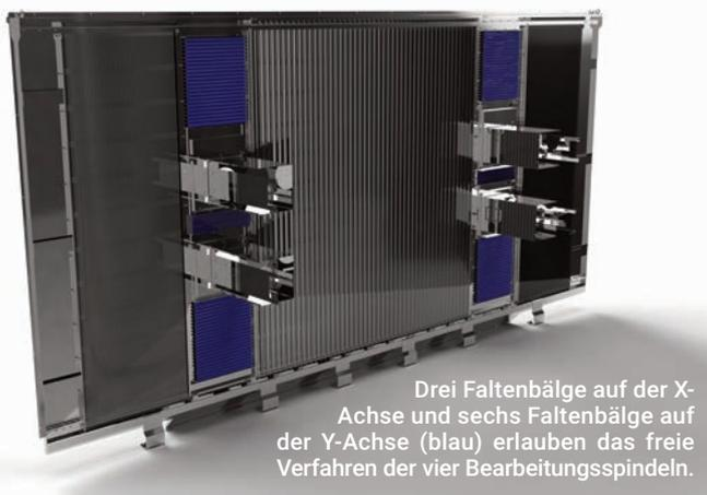
Drei Faltenbälge auf der X-Achse und sechs Faltenbälge auf der Y-Achse (blau) erlauben das freie Verfahren der vier Bearbeitungsspindeln.
