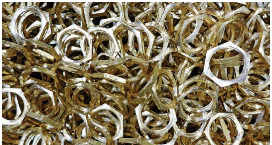
Die Werkstücke Mutter G1/2" CuZn werden in hohen Stückzahlen von etwa 400.000 Teilen pro Jahr gefertigt.
