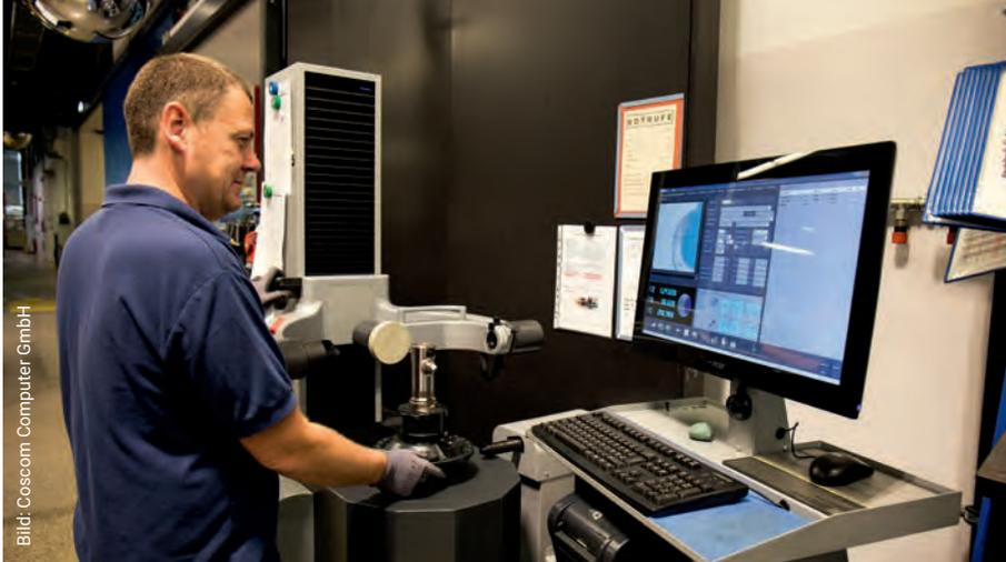
Infrastrukturell vernetzt – Der ToolDirector VM sorgt für einen harmonisierten Datenaustausch für die Voreinstellgeräte von Haimer und Zoller und bindet damit auch die Werkzeugvermessung in die digitale Fertigungsinfrastruktur und den Gesamtprozess mit ein.
