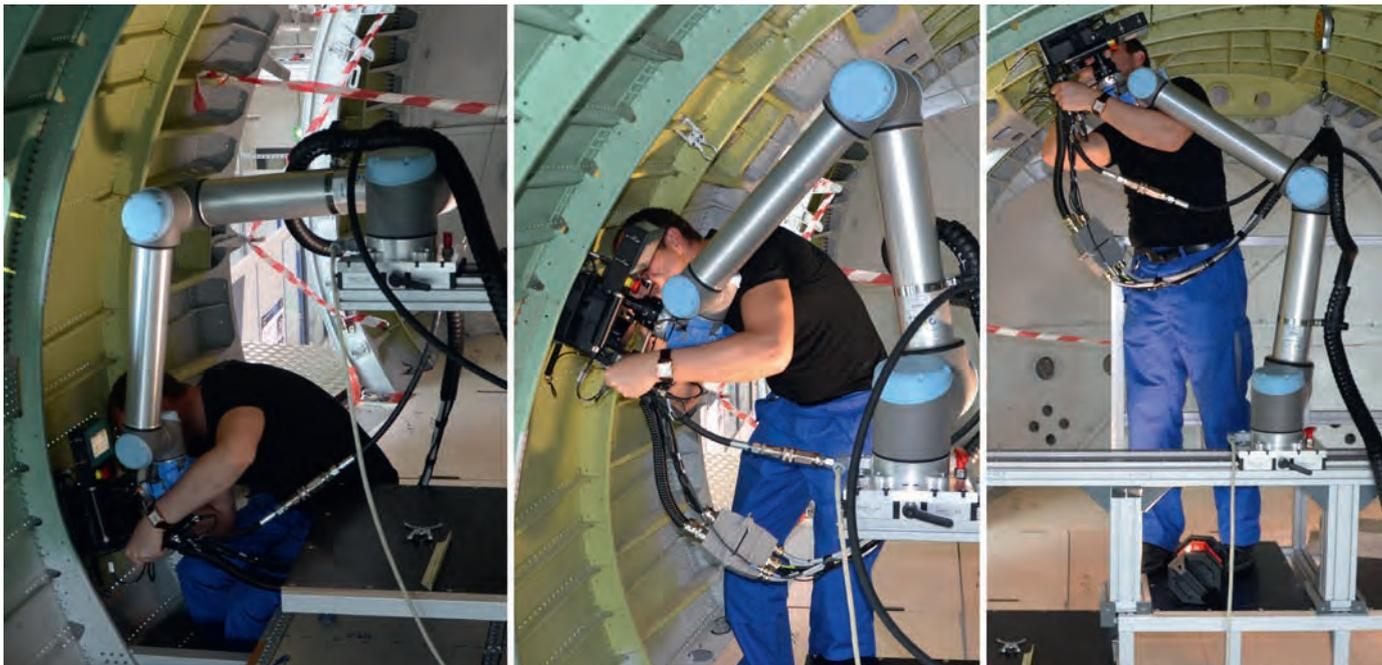
Montage einer Stringer-Kupplung mithilfe eines kollaborativen Roboters im Flugzeugrumpf
