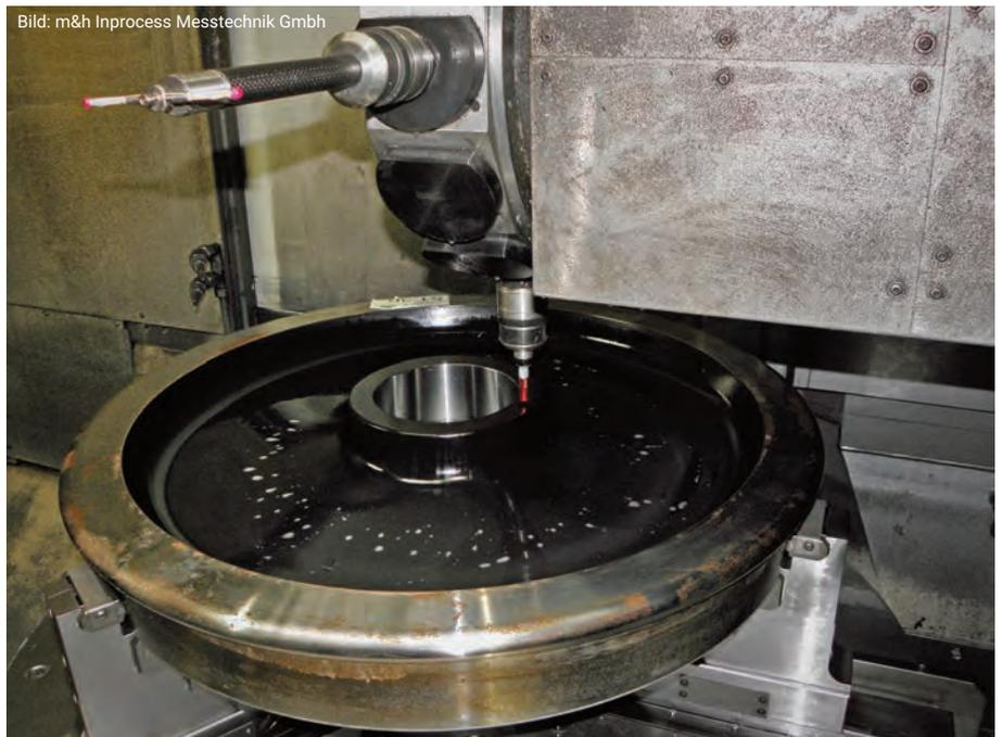
Der Temperatur-Messtaster bestimmt die Temperatur des Werkstücks, während der Messtaster mit Verlängerung im Revolver auf seinen Aufruf zur Geometriemessung wartet.
