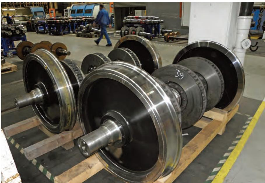
Fertigung von Radsätzen für schnelle Züge bei ÖBB Technischer Service in Knittelfeld.
