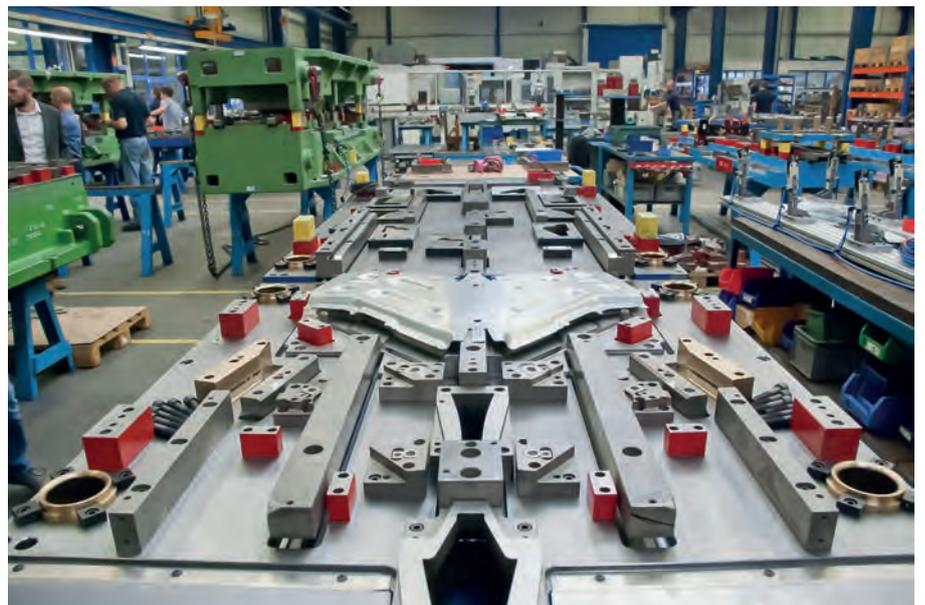
Werkzeughälfte eines Folgeverbundwerkzeuges zur Herstellung einer Verstärkung für den Hauptboden
