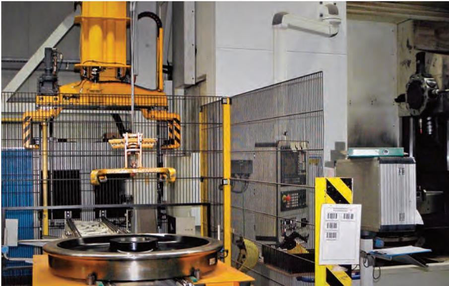
Die Radnaben werden auf einer Vertikaldrehmaschine auf genaues Paarungsmaß zur Laufachse gedreht.
