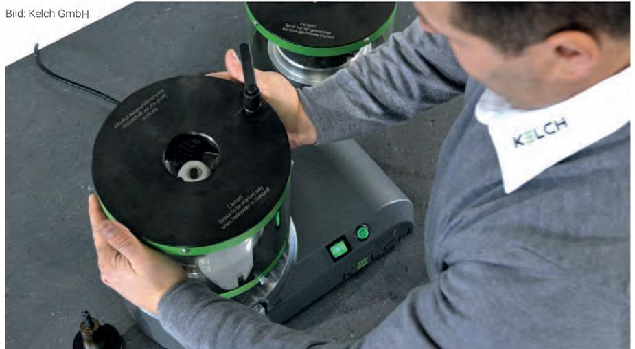
Das Standardsortiment umfasst wechselbare Reinigungsaufsätze für die Kegelarten HSK in den Größen 32 bis 100, PSC in den Größen 40 bis 100 sowie SK in den Größen 30 bis 50.
