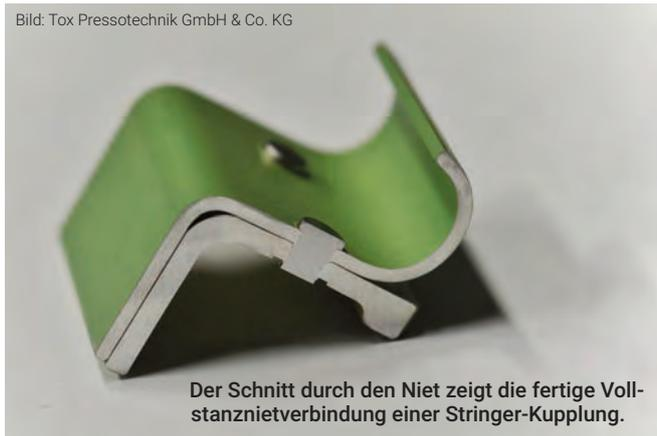
Der Schnitt durch den Niet zeigt die fertige Vollstanznietverbindung einer Stringer-Kupplung.
