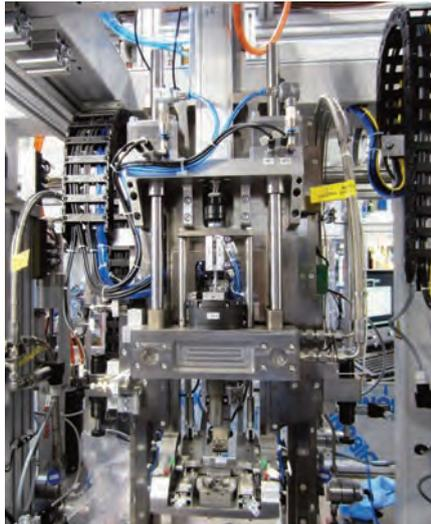
In einer aktuellen Prüfanlage wird der Prüfkopf von einem elektrischen Antrieb bewegt und während des 30 sekündigen Prüfvorgangs exakt von ACE-Klemmelementen fixiert.
