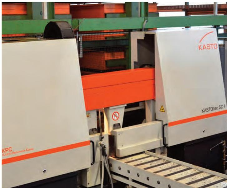
Die Hochleistungsbandsäge Kastotec SC 4 ist für das Trennen großer Werkstücke, insbesondere Vollmaterialien und schwer zerspanbarer Werkstoffe konzipiert.
