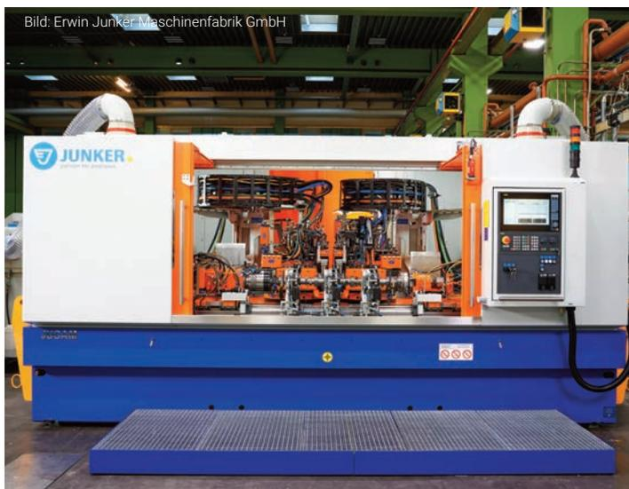
Unrundschleifmaschine: Die neue Jucam 6L bearbeitet die Lkw-Nockenwellen in einer Einspannung effizient und hochpräzise.
