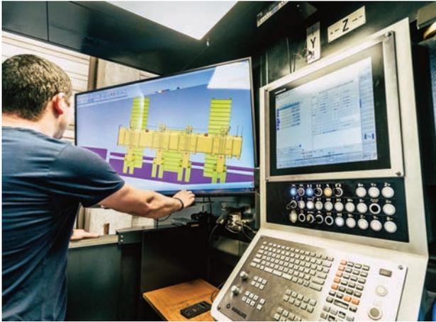
Datenvisualisierung direkt an der Maschine: Blick in den Coscom InfoPoint VM an einer CNC-Fräsständermaschine
