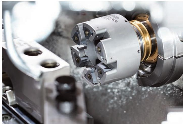
Rotationssymmetrische Werkstücke sind bei dieser Maschinenauslegung gefräst und nicht gedreht.
