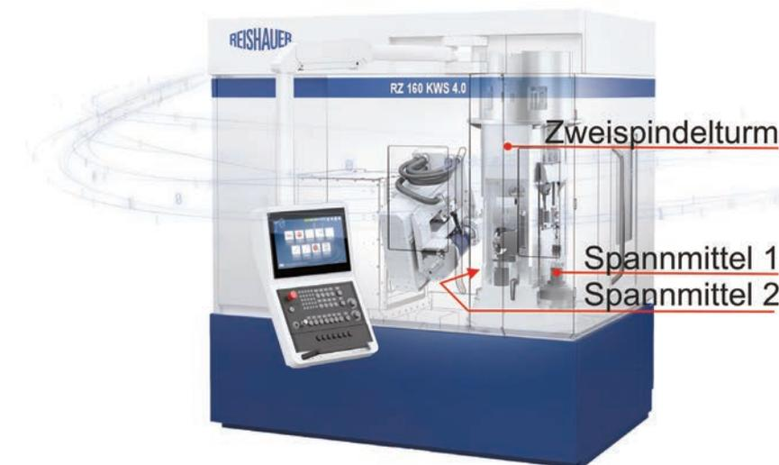
Wälzschleifmaschine RZ160 KWS 4.0
