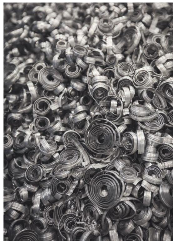
Die Aluminium-Späne werden gesammelt und unter hohem Druck zu Briketts zusammengepresst. So wird nicht nur das Volumen reduziert, sondern auch der Kühlschmierstoff herausgepresst. Aus den Späne-Briketts wird wieder ein Rohblock aus Aluminium, der weiterverarbeitet werden kann.
