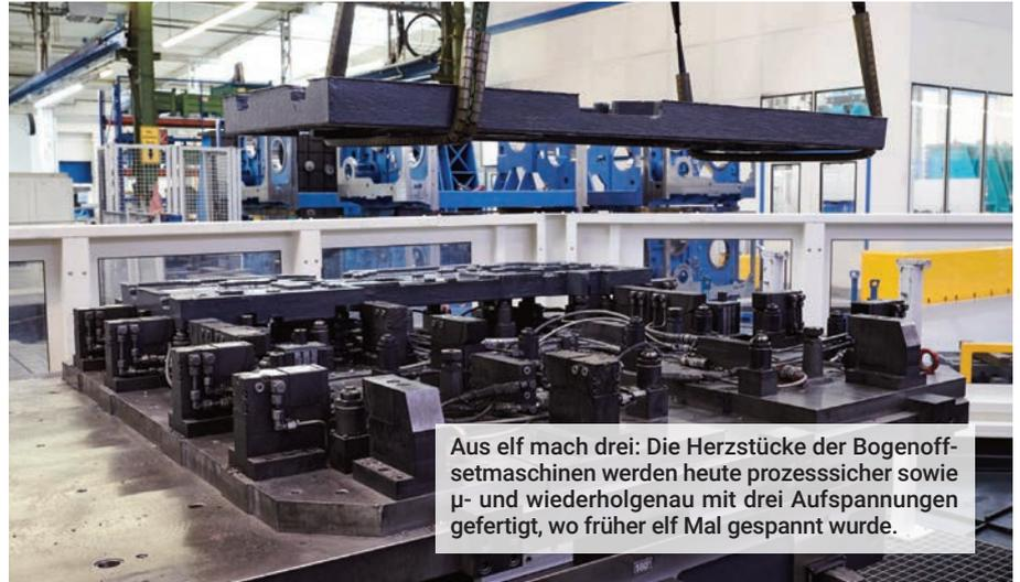
Aus elf mach drei: Die Herzstücke der Bogenoffsetmaschinen werden heute prozesssicher sowie  $\mu$ - und wiederholgenau mit drei Aufspannungen gefertigt, wo früher elf Mal gespannt wurde.
