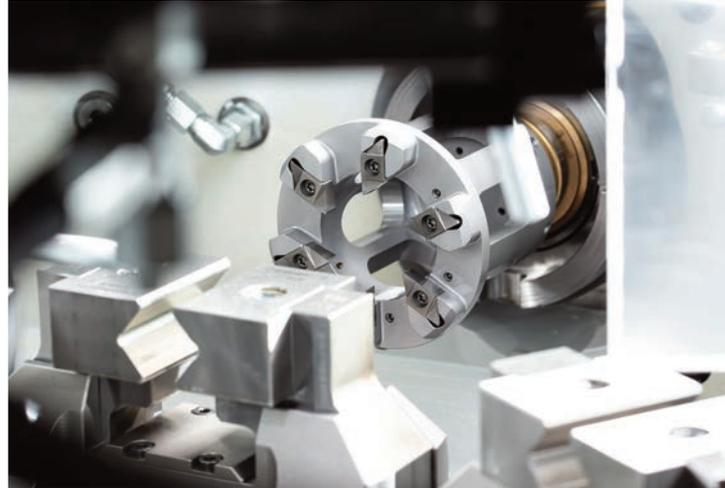
Der Horn-Glockenfräser bearbeitet die Außenkontur der langen Werkstücke.
