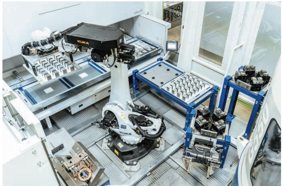
Ein KR Quantec von Kuka entnimmt eine Palette mit Rohlingen, nachdem diese in die Zelle eingeschleust wurde.
