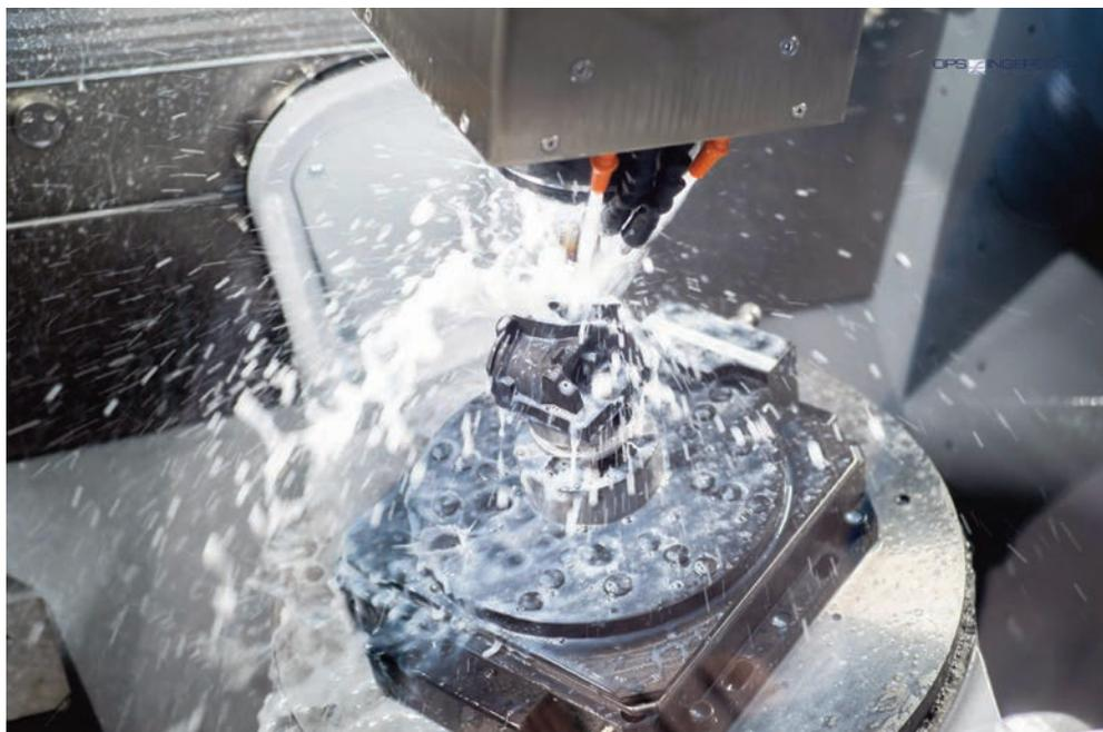
Aktuell bietet OPS-Ingersoll auch eine HSK E 50-Spindel mit 21Nm und 36.000U/min an – aufgrund der Leistungsdaten eine optimale Kombination für das Fräsen von Kupfer- und Grafitelktroden sowie Stahl.
