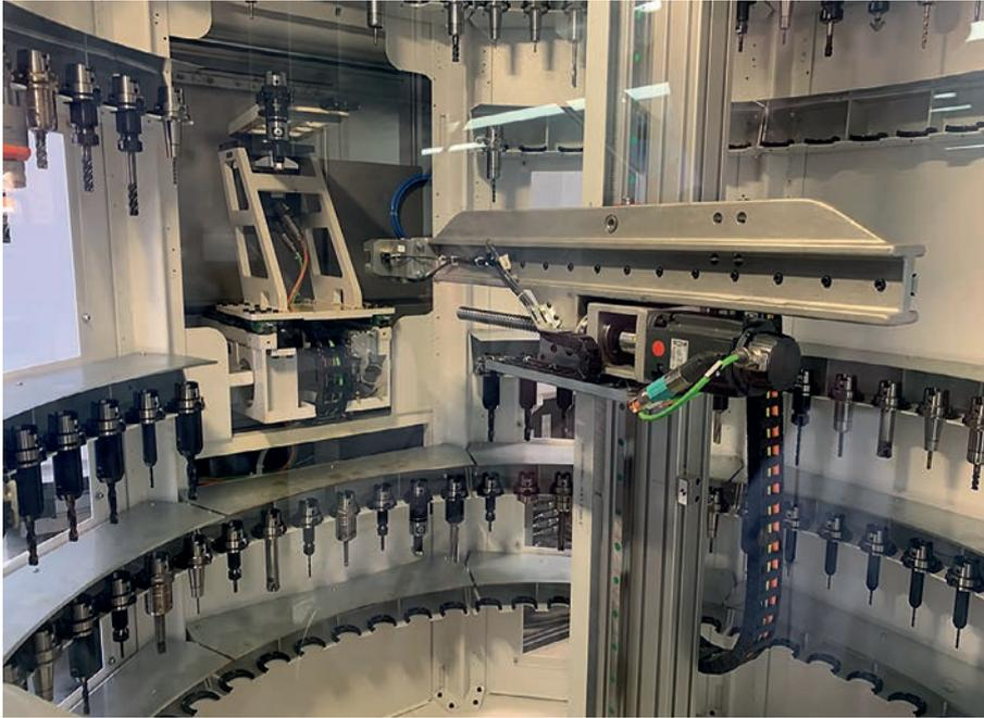
Die CNC-Fräsmaschine verfügt über ein Werkzeugmagazin mit 238 Plätzen.
