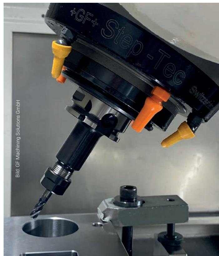
Die Schwenkachse bietet auch seitlich optimalen Zugang zum Werkstück.
