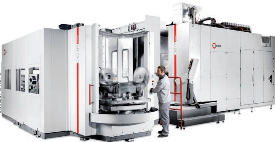
Der Palettenwechsler PW 3000, hier in Kombination mit dem 5-Achs-Bearbeitungszentren der High-Performance-Line C 62 U, bewegt bis zu drei Tonnen schwere Werkstücke.
