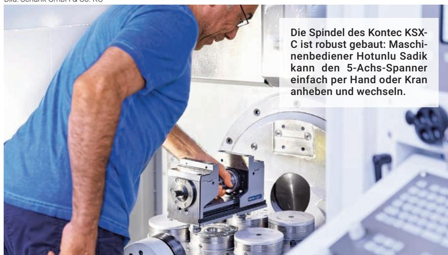
Die Spindel des Kontec KSX-C ist robust gebaut: Maschinenbediener Hotunlu Sadik kann den 5-Achs-Spanner einfach per Hand oder Kran anheben und wechseln.
