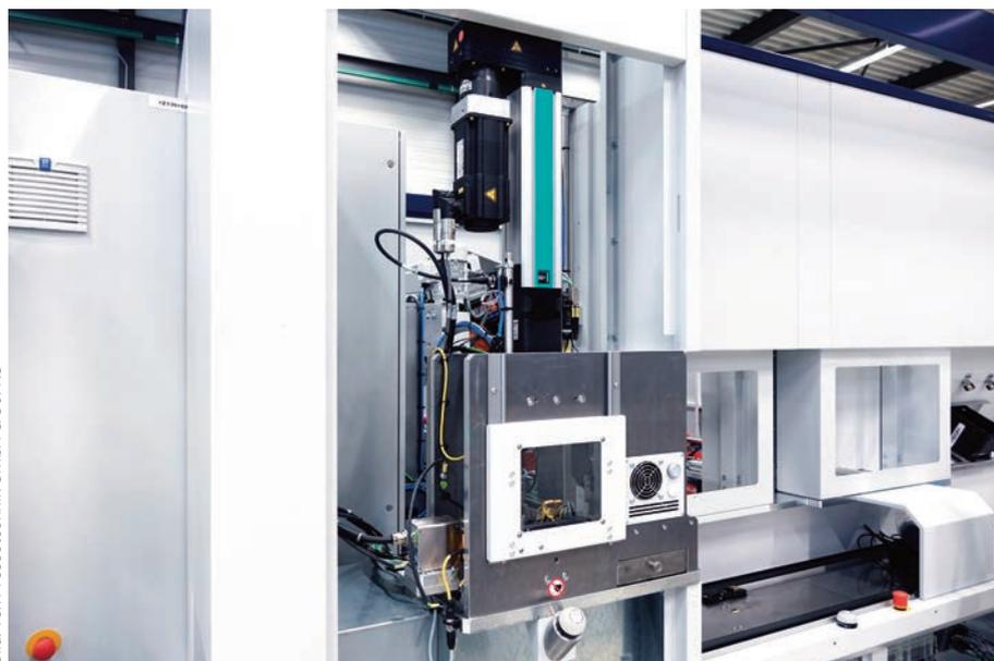
Zum Einsatz kommen in der neuen Fertigungslinie von Pierburg sowohl das pneumohydraulische Tox-Kraftpaket als auch der elektromechanische Antrieb Tox-ElectricDrive.
