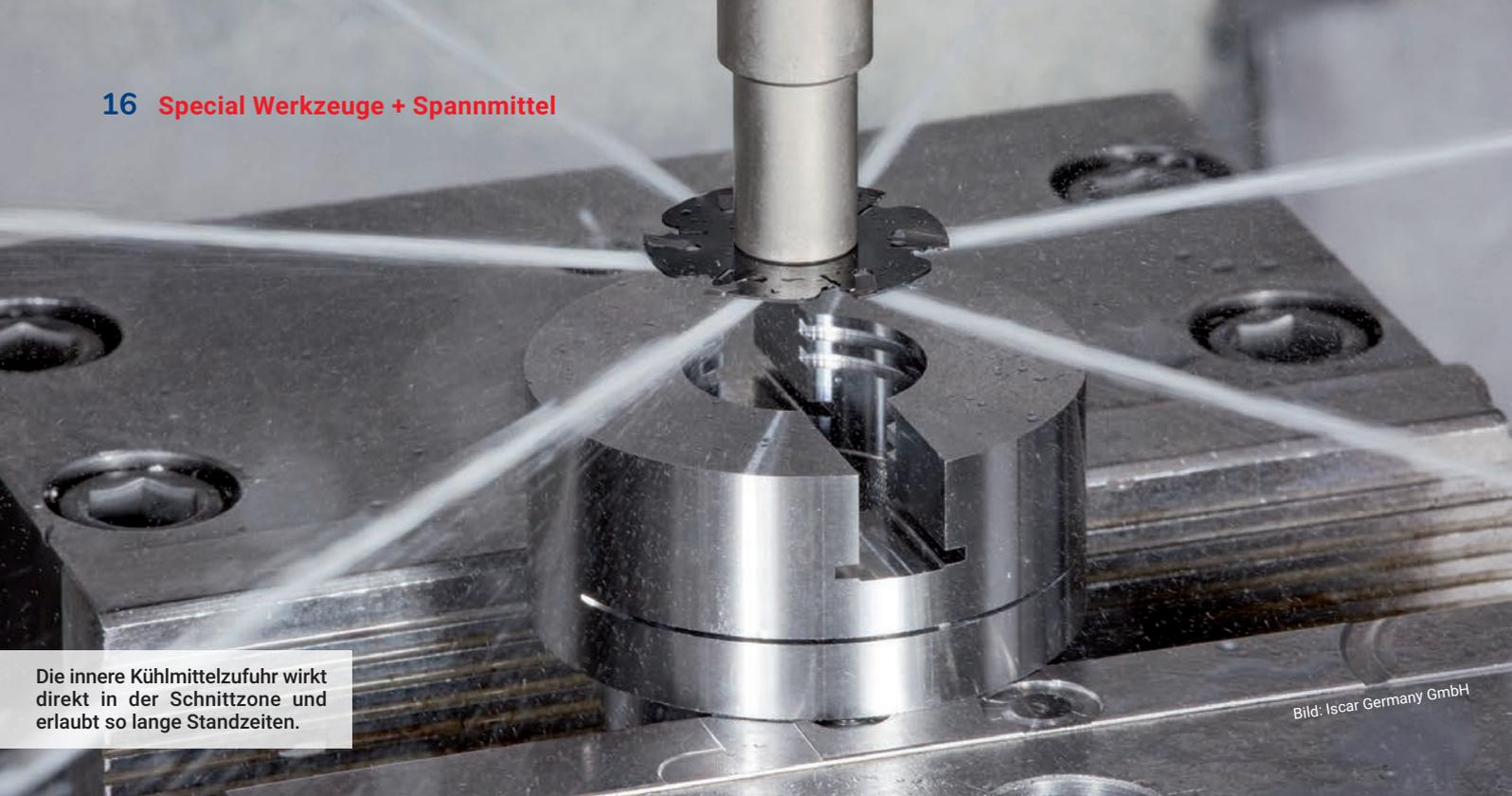
Die innere Kühlmittelzufuhr wirkt direkt in der Schnittzone und erlaubt so lange Standzeiten.
