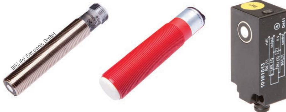
Links zwei Ultraschalltaster als Gewindegereäte, die in einem Temperaturbereich von -25°C bis +70°C einsetzbar sind (Schaltabstände von 200mm bis 6m), rechts eine Ultraschallreflexschranke für einen Einsatztemperaturbereich zwischen -10°C und +60°C. Die aktiven Flächen bestehen bei allen Sensoren aus Kunststoff.
