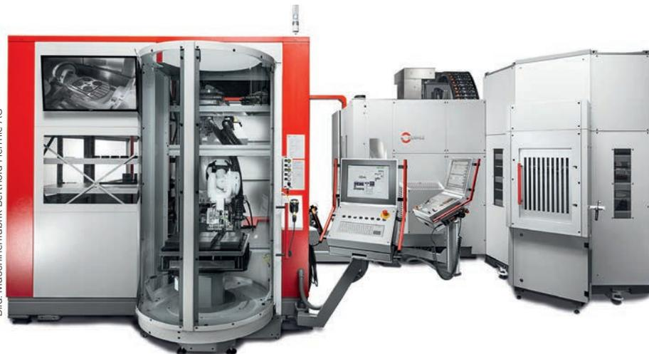
Das Robotersystem RS 3 automatisiert die C 32 U und handhabt bis zu 420kg schwere Werkstücke.
