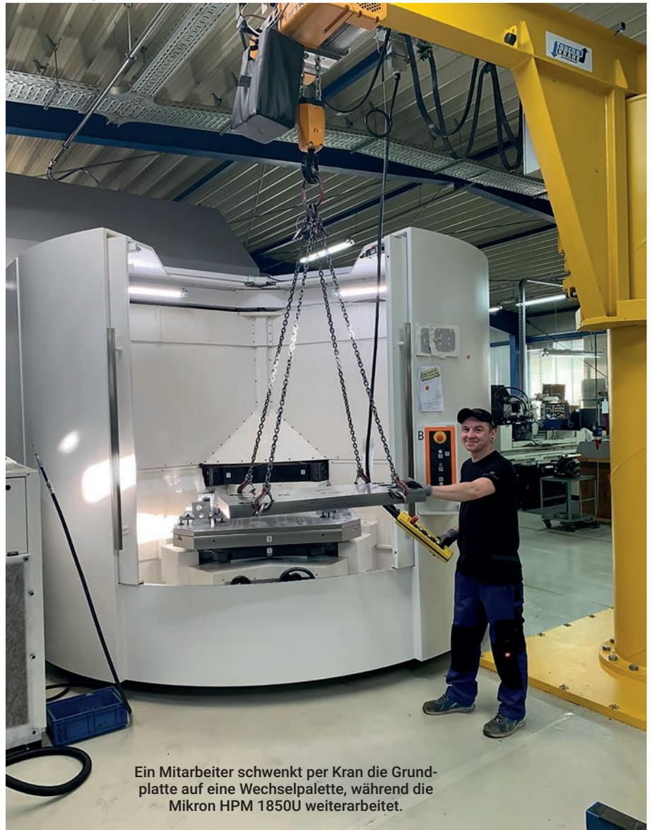
Ein Mitarbeiter schwenkt per Kran die Grundplatte auf eine Wechselpalette, während die Mikron HPM 1850U weiterarbeitet.
