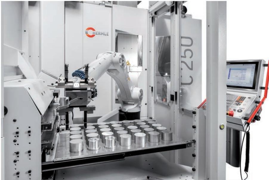
Mit dem Doppelgreifer handhabt der Roboter zum einen Rohlinge und zum anderen die fertigen Werkstücke ohne langwierige Greiferwechsel.
