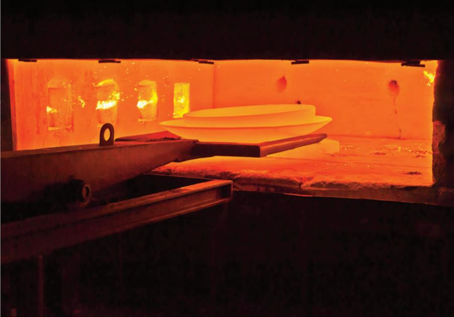
Durchgängig: AM-Lock-Paletten sind bis 650°C wärmebeständig – so können gedruckte Teile ohne vorherige Trennung von der Palette direkt in den Glühofen.
