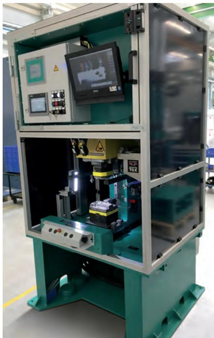
Kompakt im Aufbau: Auf dem Universaluntergestell sind Presse, Steuerung und Prozessüberwachung übersichtlich untergebracht.
