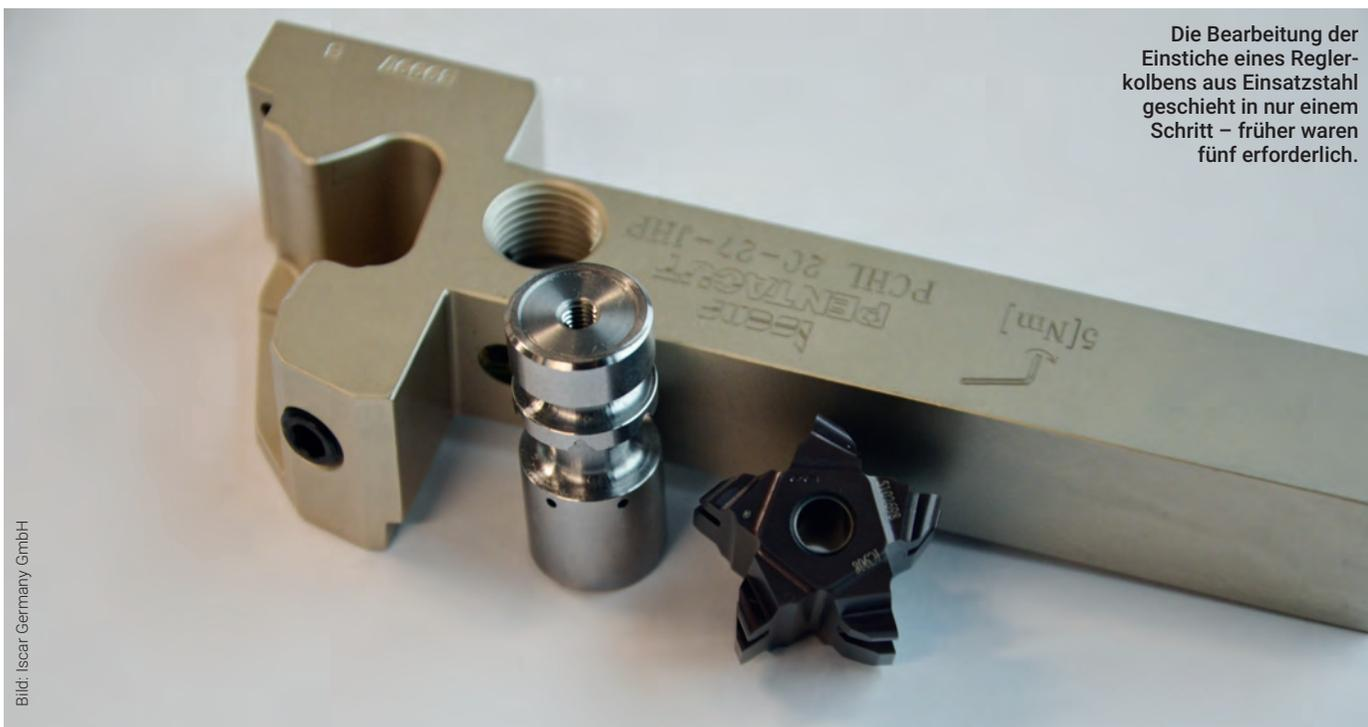
Die Bearbeitung der Einstiche eines Reglerkolbens aus Einsatzstahl geschieht in nur einem Schritt – früher waren fünf erforderlich.
