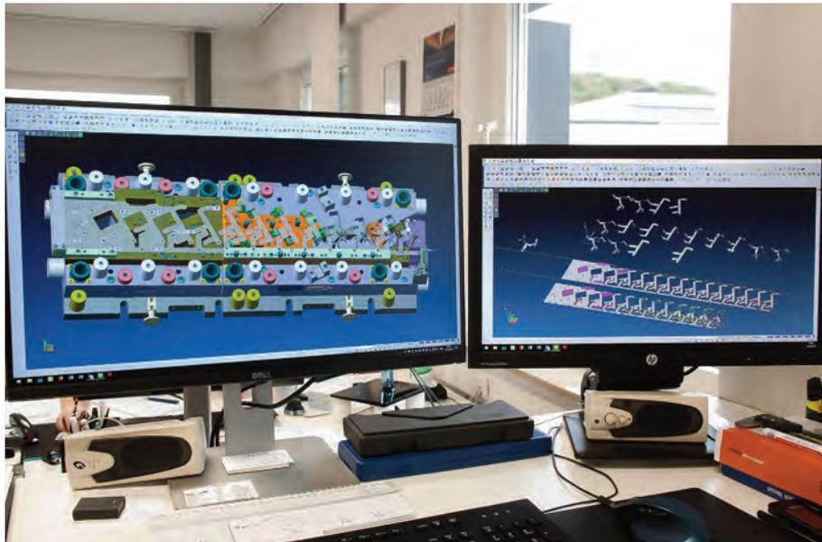
Der linke Bildschirm zeigt die Unterseite des mit Visi konstruierten Folgeverbundwerkzeugs für die Halterung, rechts ist das Streifenlayout zu sehen.
