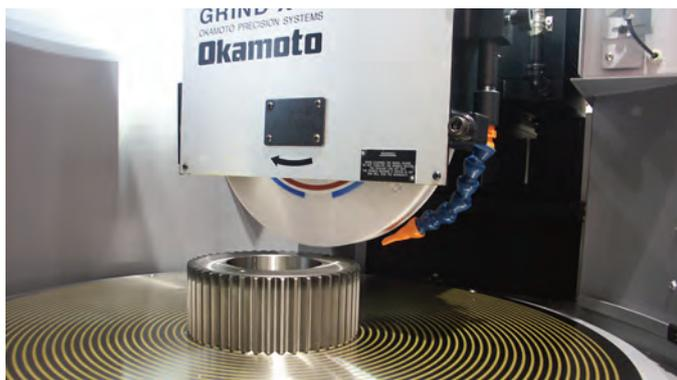
Um eine besonders hohe Präzision beim vibrationslosen Schleifen zu erzielen, sind die Rundtischschleifmaschinen mit einer hydrodynamischen Lagerung für den Maschinentisch ausgestattet.
