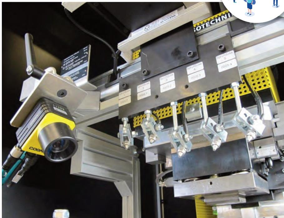
Fünf auf einen Streich: Das Mehrpunktwerkzeug von Tox Pressotechnik erlaubt das gleichzeitige Anbringen von fünf Sicherungen auf einer Stromschiene in nur einem Hub.
