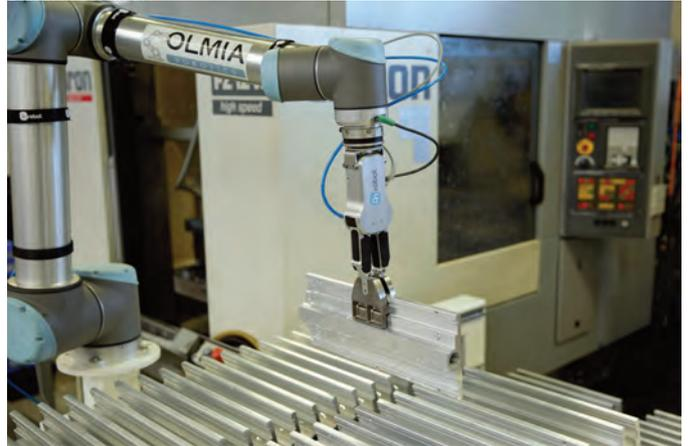
Der RG6-Greifer entnimmt ein Bauteil aus der Robobooster-4000-Beladestation und setzt es dort nach dem Fräsvorgang wieder ein.
