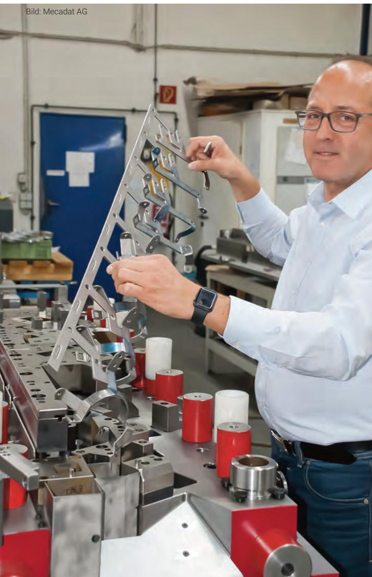
Eine Hälfte des fertig montierten Folgeverbundwerkzeugs für einen Halter: Firmenchef Frank Ebel hält den dazugehörigen Teststreifen in der Hand.
