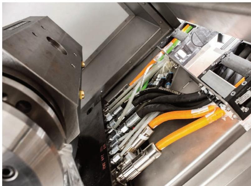
Für eine sichere Energie- und Medienzufuhr des Multifunktionskopfes kommen Igus Leitungen und Energieketten fertig montiert mit Steckern in der z-Achse zum Einsatz.
