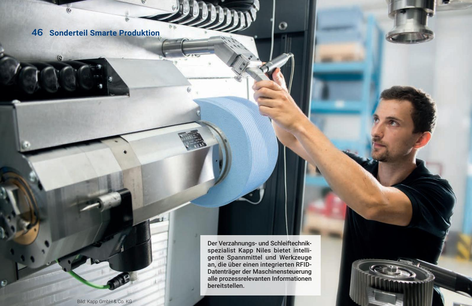
Der Verzahnungs- und Schleiftechnikspezialist Kapp Niles bietet intelligente Spannmittel und Werkzeuge an, die über einen integrierten RFID-Datenträger der Maschinensteuerung alle prozessrelevanten Informationen bereitstellen.
