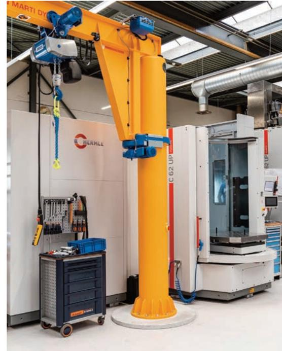
Fertig für die mannlose Schicht: C 62 U mit Palettenwechsler PW 3000
