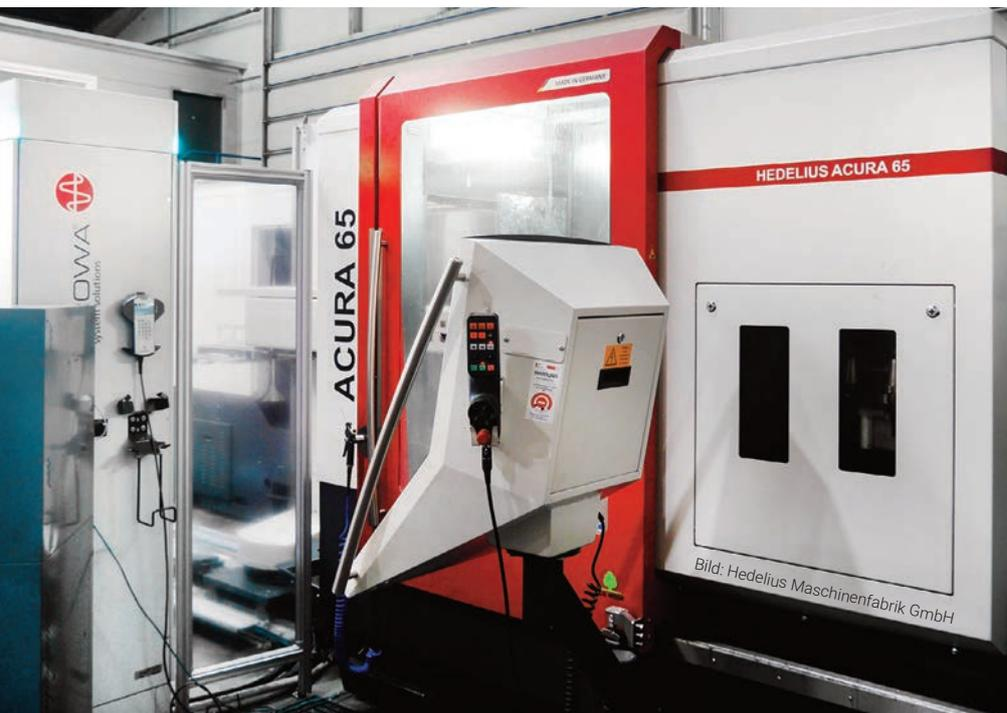
Zwei Acura 65 EL sind über eine lineare Erowa-Palettenautomation verkettet. Die seitliche Beladung ermöglicht weiterhin die Zugänglichkeit zum Arbeitsraum von vorne.
