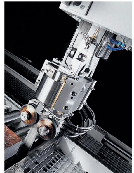
die Säge als halbautomatische Variante Kastobbs U sowie als vollautomatische Ausführung Kastobbs A an. Letztere ver- fügt neben elektromotorisch angetriebe- nen Vorschubeinheiten und Werkstück- anschlügen auch über eine optional verfügbare Funktion der 0/90°-Bandver- drehung. Damit ist der Anwender in der Lage, Werkstücke sowohl in Längs- als auch in Querrichtung zur Rollenbahn zu sägen – für einen mannslosen Betrieb vom vollständigen Block bis zum fertig zugeschnittenen Werkstück.
