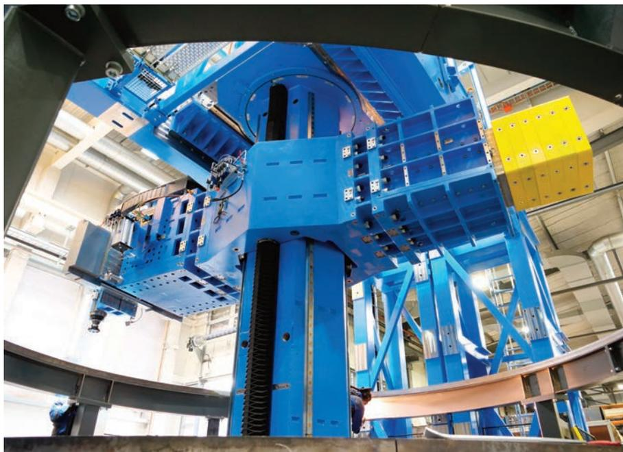
Links eine drehmomentstarke Getriebe-Frässpindel, rechts in Gelb das Gegengewicht: Beide Achsen werden mittels INA-Profilschienenführungen von Schaeffler in X-Richtung geführt. Auf der Hauptwelle sind vier INA-Profilschienenführungen (Baugröße 65) mit Corrotect-Beschichtung verschraubt.
