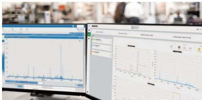
AutinityVC ist eine Software zur Schwingungsanalyse, die während der laufenden Produktion Daten von Vibrationssensoren auswertet, mit hinterlegten Referenzwerten vergleicht und bei Abweichungen sofort reagiert. Ziel ist die 100%ige Teilekontrolle in der Maschine über alle Arbeitsschritte und Fertigungsprozesse hinweg – live während der Produktion.
