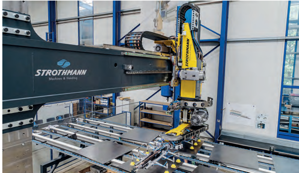
Antriebstechnik von Wittenstein kommt in allen Achsen des FeederPlus 6 neo zum Einsatz.
