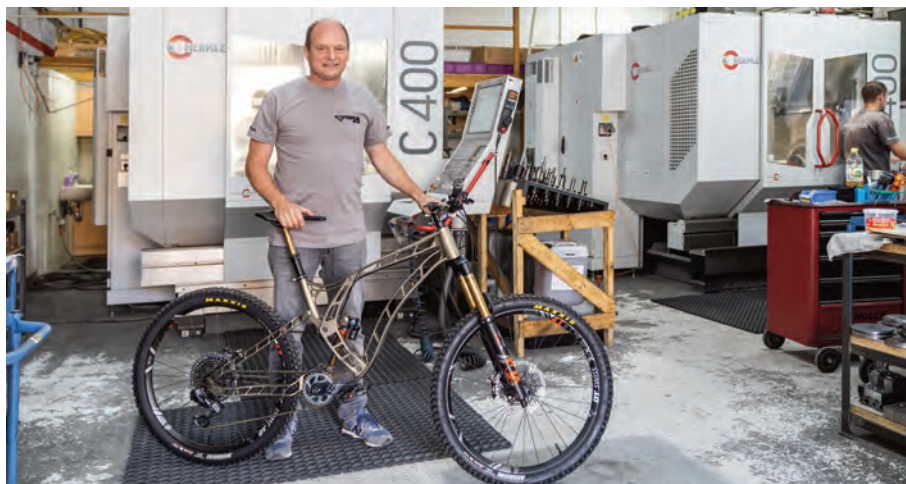
Auf den C 400 U von Hermle verwirklicht Bernd Iwanow seine Idee von einem CNC-gefästen Fahrrad. Mit Federgabel, Schaltung und Bremsanlage wiegt es rund 17kg.
