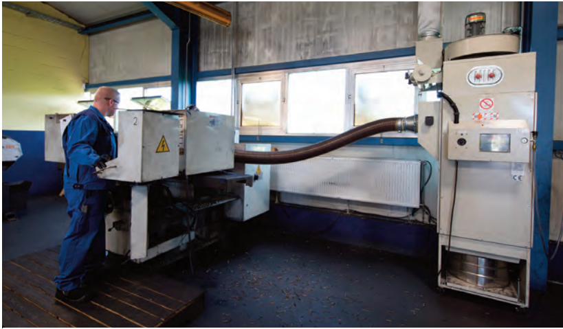
Bild links: Die Entstauber der DS-Serie – hier bei Drebelow & Jahn – lassen sich aufgrund ihrer modularen Bauweise ausgezeichnet an den individuellen Anwendungsfall anpassen.
