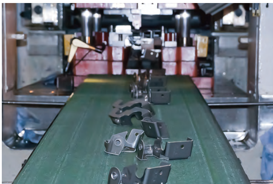
Teileproduktion auf einer der automatisch laufenden Exzenterpressen mit Coilszuführung.
