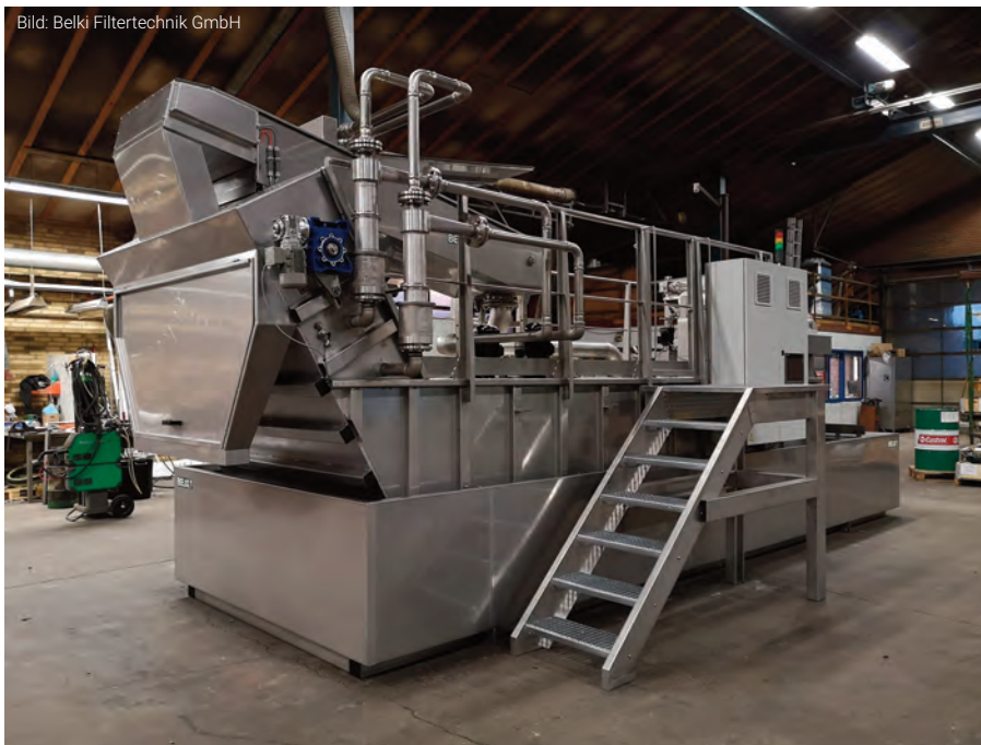
Belki Zentralanlagen zur Reinigung von Kühlschmierstoffen oder anderen Prozessflüssigkeiten arbeiten betriebssicher, sorgen für eine hohe Effizienz und erfordern nur minimale Wartung.
