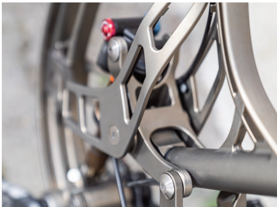
Das Facebike kommt ohne Schweißnähte aus: 15 Titanschrauben halten die acht Rahmenkomponenten zusammen.
