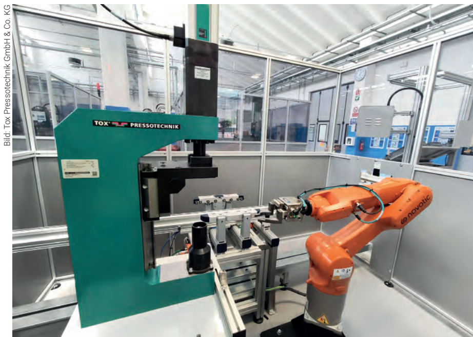
Tox Pressotechnik lieferte Systemintegrator Novotic Pressstationen für eine Montageanlage für Getriebebaugruppen von Bonfiglioli.
