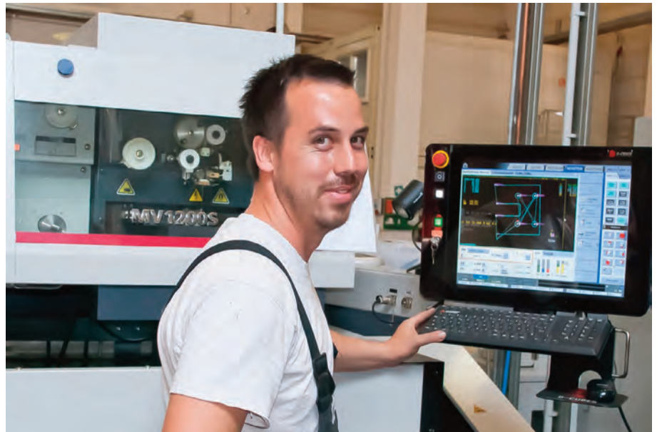
CAM-Leiter Carsten Zejunc an der CNC einer der drei Drahterodiermaschinen von Mitsubishi, die von Visi Peps Wire mit Erodierprogrammen versorgt werden.
